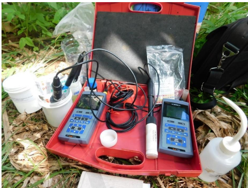
Illustration 27 : Vérification du matériel de suivi des paramètres physico-chimiques à l'aide de solutions tampons.
