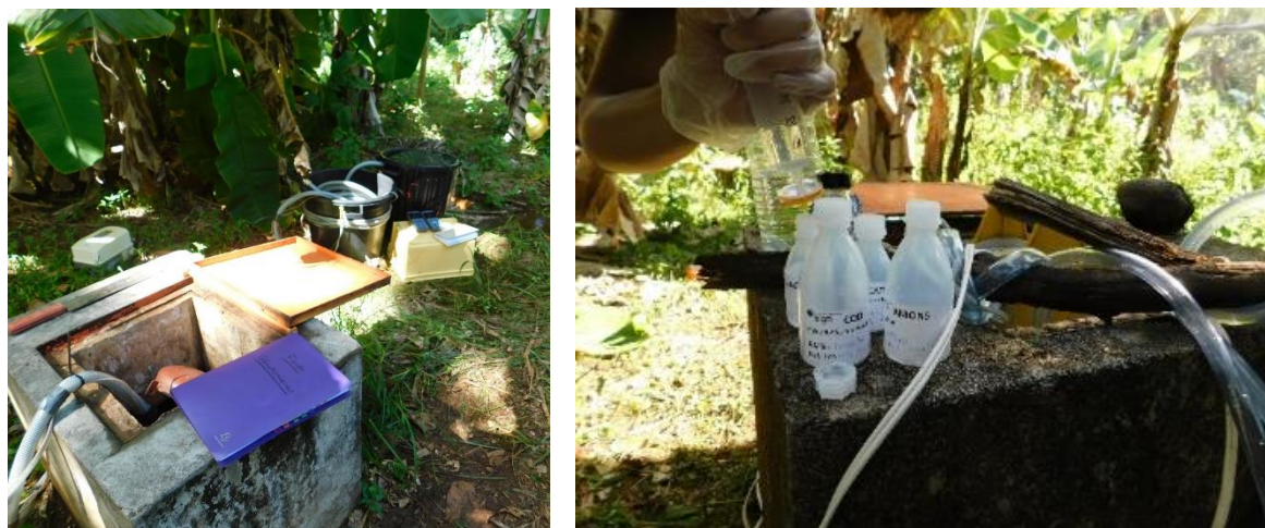
Illustration 38 : Réalisation du pompage et conditionnement sur le piézomètre de Dzoumogné.
