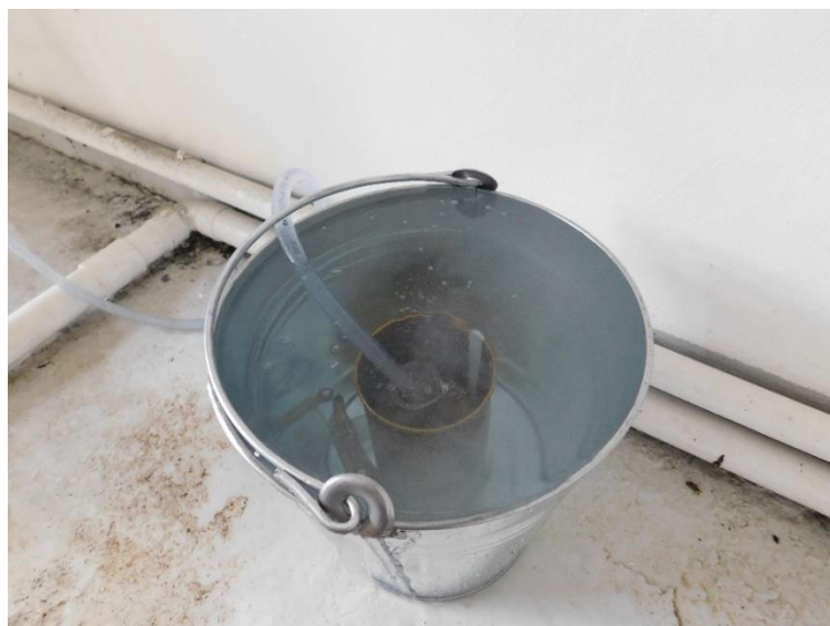
Illustration 36 : Matériel utilisé pour le prélèvement des CFC et SF6
