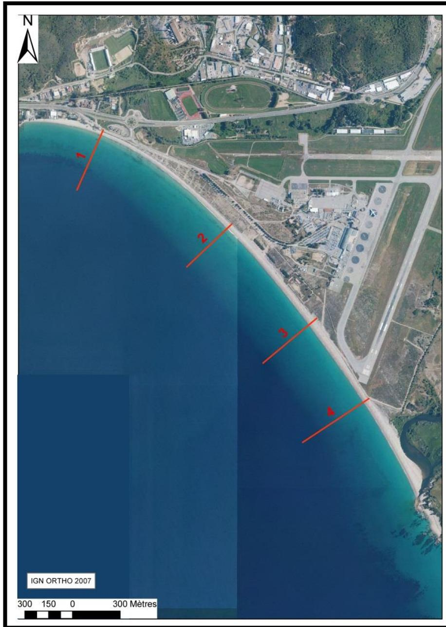
*Illustration 12 – Positionnement des profils topo-bathymétriques réalisés sur la plage du Ricanto (IGN ORTHO® 2007).*
