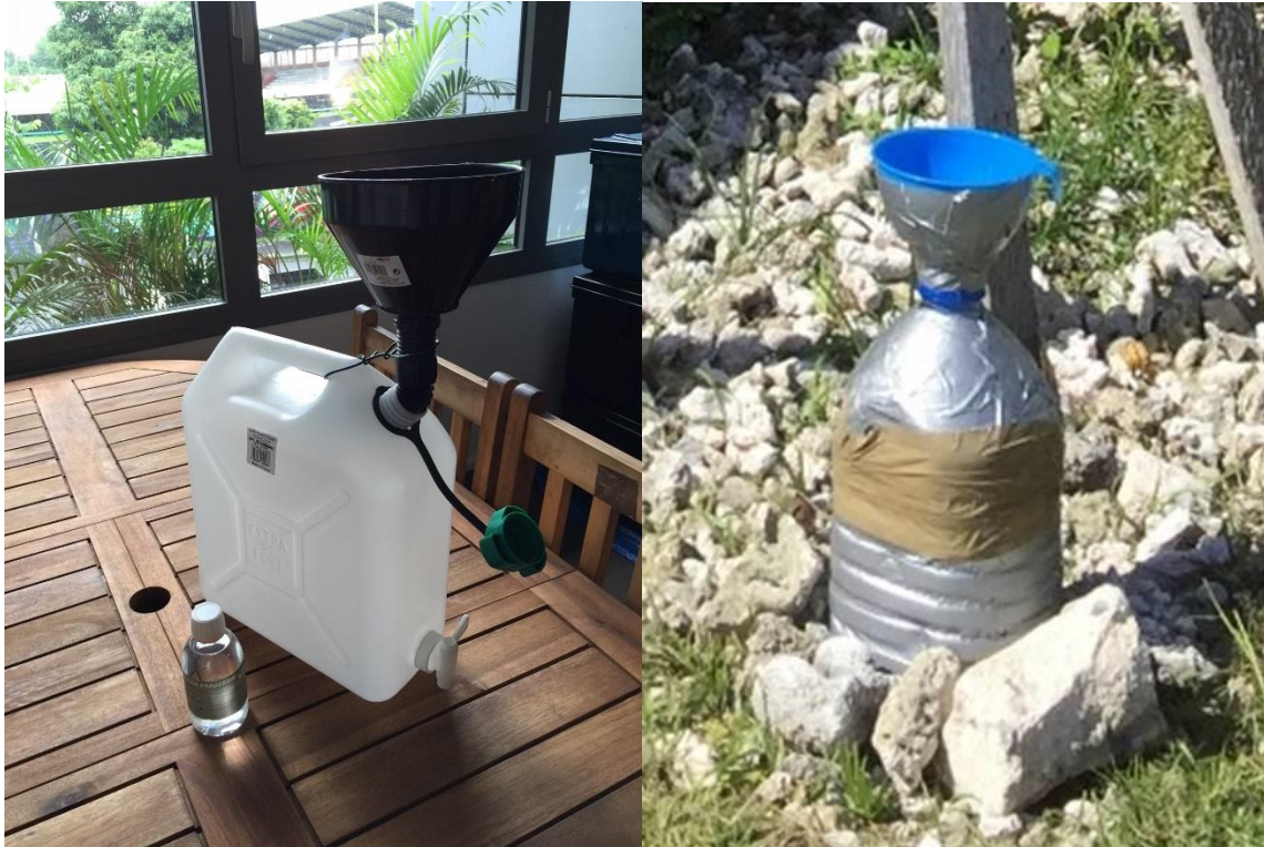
Illustration 12 : Ancien et nouveau dispositifs mis en place pour la récupération des eaux de pluie.
