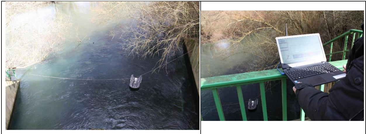
Illustration 7 : Mesure de débit par bateau Doppler en sortie de galerie de Moyeuvre-Grande
