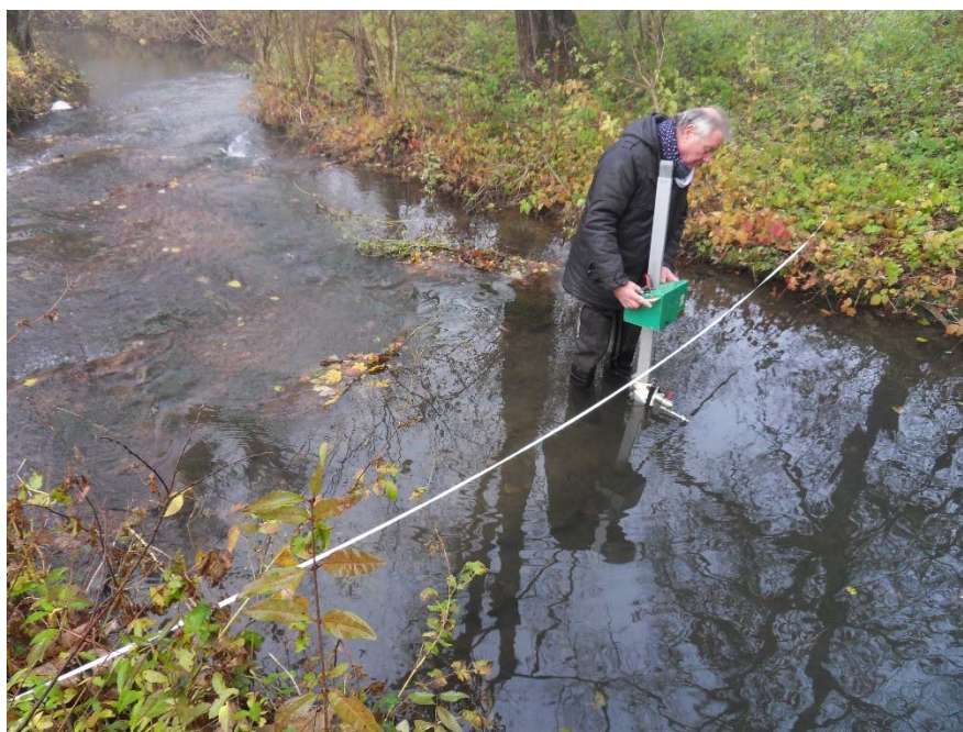
Illustration 6 : Jaugeage au micromoulinet du Conroy
