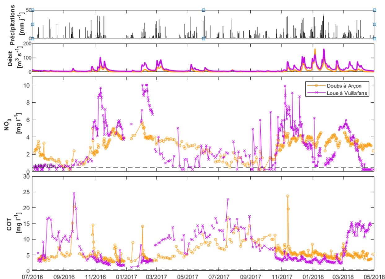
Illustration 34 – Evolutions de la concentration en \text{NO}_3 et COT sur les stations QUARSTIC d'Arçon et de Vuillafans
