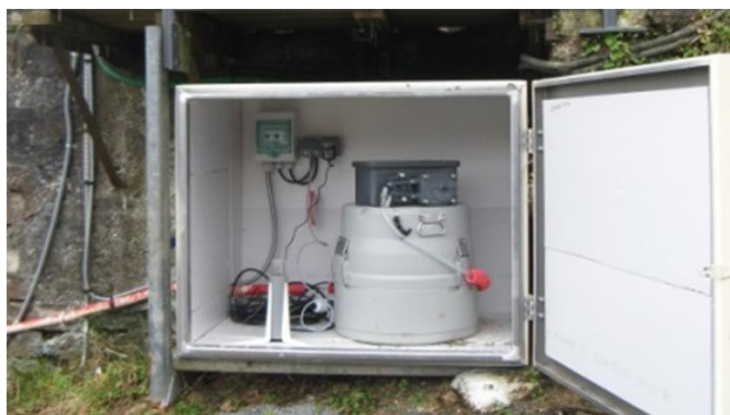
Illustration 5 – Instrumentation de base sur les stations QUARSTIC avec à gauche une sonde multi-paramètres (MS5 Hydrolab, OTT), et à droite un échantillonneur portable (3700, 24 flacons, ISCO).
