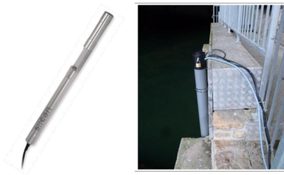
Illustration 6 – Installation de la sonde à spectrométrie UV-Vis (spectro::lyser, s::can, Measuring Systems), à la source de la Loue (photo BRGM©)
