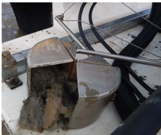
*Illustration 4: Exemple de prélèvement à la benne (ici de la vase) ayant permis de calibrer les données acquises par sonar à balayage latérale et effectué dans le cadre de la campagne de novembre 2017 (©BRGM).*
