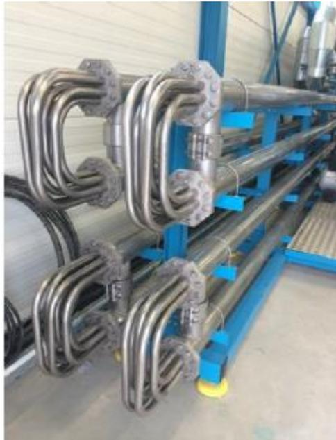
Figure 7 : Échangeurs de chaleur utilisés dans la mine à ciel ouvert de Hambach (Thien, 2015).
