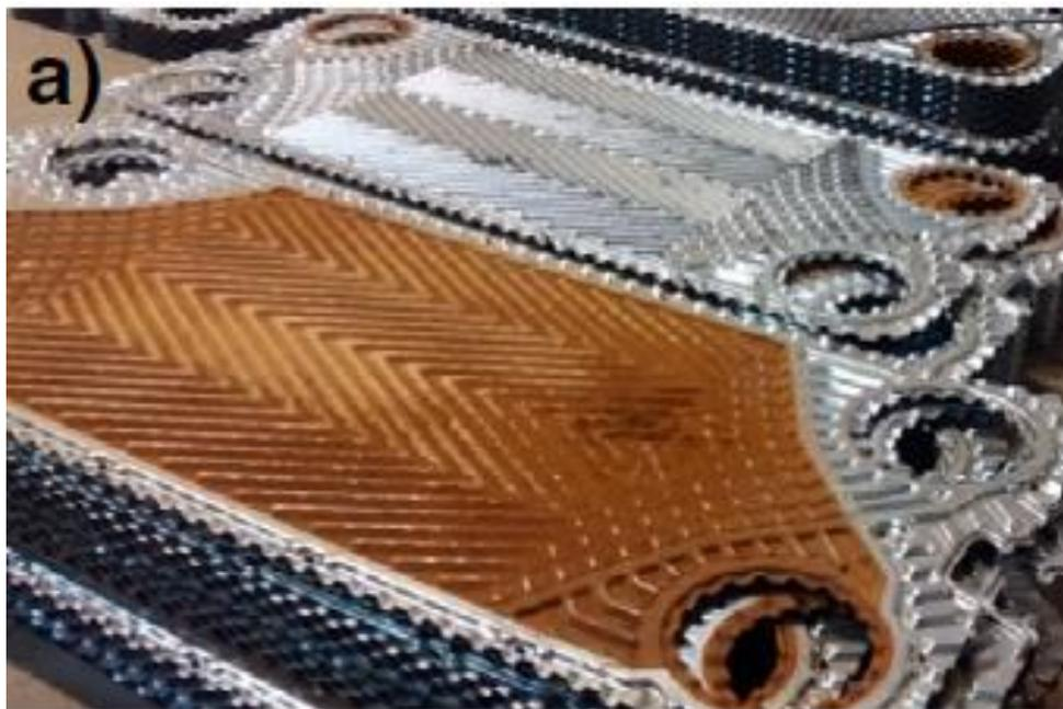
Figure 24 : Dépôts observés sur un échangeur à plaques sur le site de Barredo-Figaredo (source : Loredó et al., 2017).
