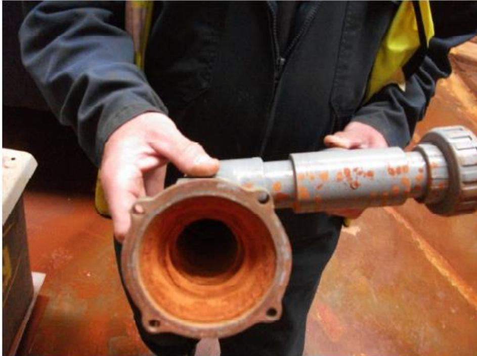
Figure 15 : Dépôts d'hydroxyde de fer à l'entrée de l'échangeur (source : Bailey et al., 2013).
