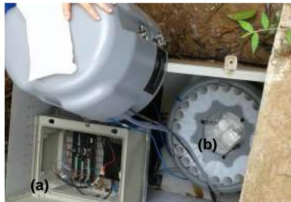
Centrale d'acquisition des données (a) et préleveur de m.e.s (b) d'une station hydro-sédimentologique
