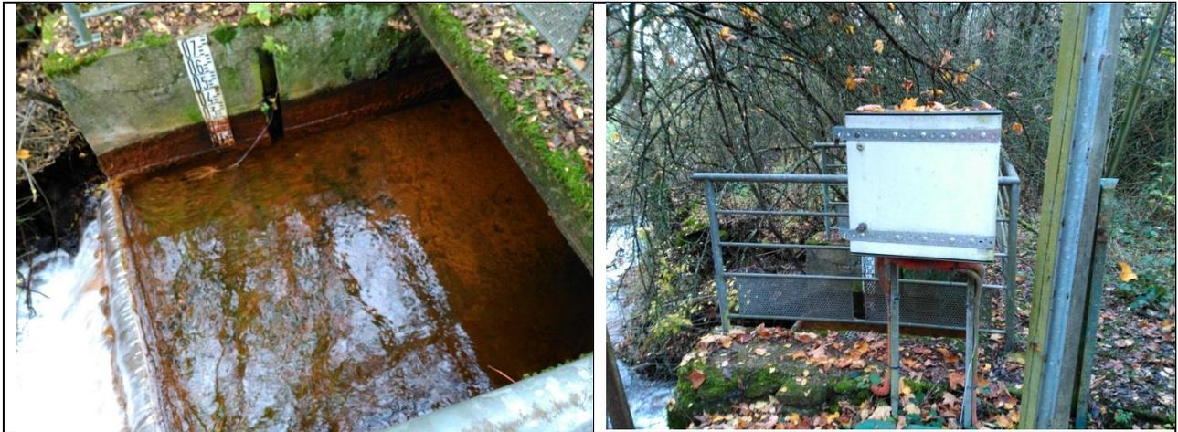
*Illustration 18 : Mesure automatique des hauteurs d'eau par capteur « bulle à bulle » Hydrosens sur une section aménagée de la station du Woigot*
