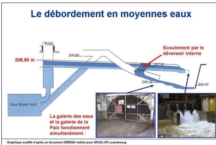
**2) En période de moyennes eaux :** lorsque le niveau du réservoir dans le puits de Havange dépasse la cote 208,85 m NGF, soit pour un débit de débordement supérieur à 2,3 m<sup>3</sup>/s, la galerie des eaux se déverse dans la partie aval de la galerie de la Paix par l'intermédiaire du déversoir interne ; et les deux galeries de débordement fonctionnent simultanément. Cette configuration a été observée en 2008 uniquement
