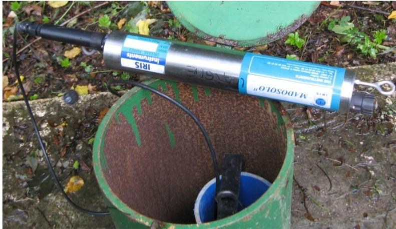
Illustration 17 : Appareil de mesure piézométrique et d'enregistrement Madosolo (IRIS ©)
