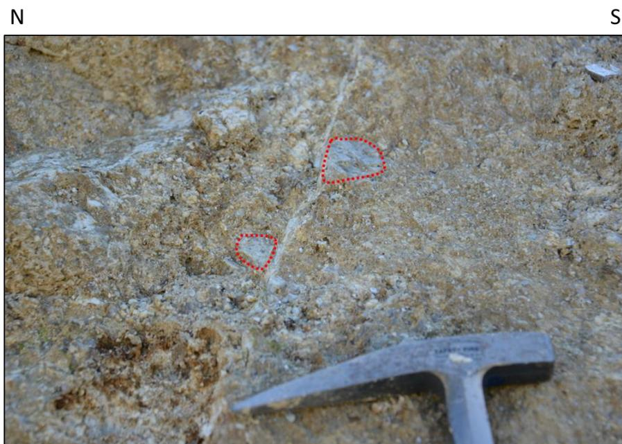
Illustration 26 - Exemple de faille normale N100 à regard nord dans la sablière au nord d'Ax-Bonastre. La veine de quartz surlignée en rouge est décalée d'environ 10 cm, le compartiment abaissé est au nord.
