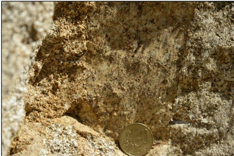
Illustration 18 – Stries normales dans les arènes du granite de Bordères (le nord est à gauche). Plan de faille 172W85, stries à pitch 70°N (affleurement 3824)
