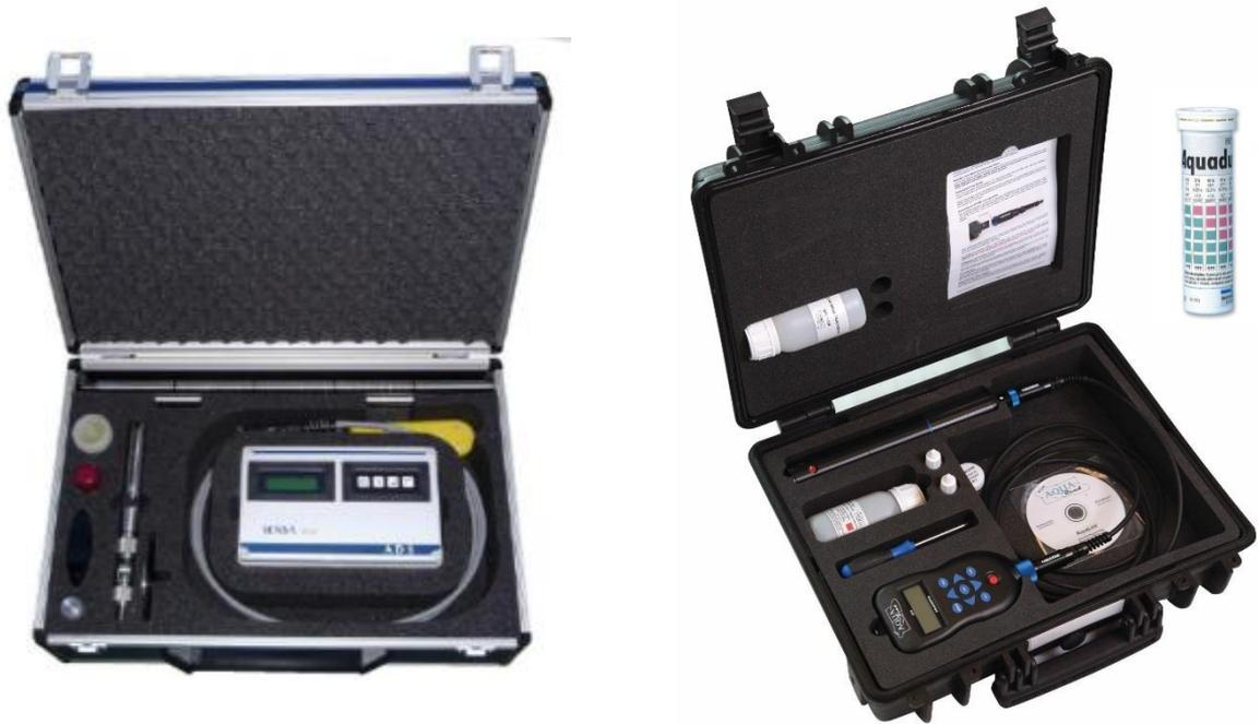
*Illustration 2 : Courantomètre électromagnétique, sonde multiparamètres et tests colorimétriques.*
