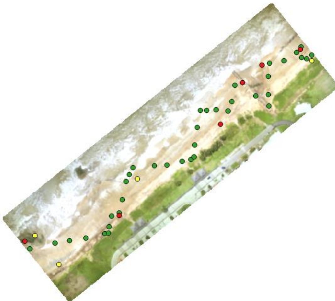
Illustration 7: orthophotographie avec les points de contrôle (en vert), les points homologues (en rouge) et les cibles (en jaune).
