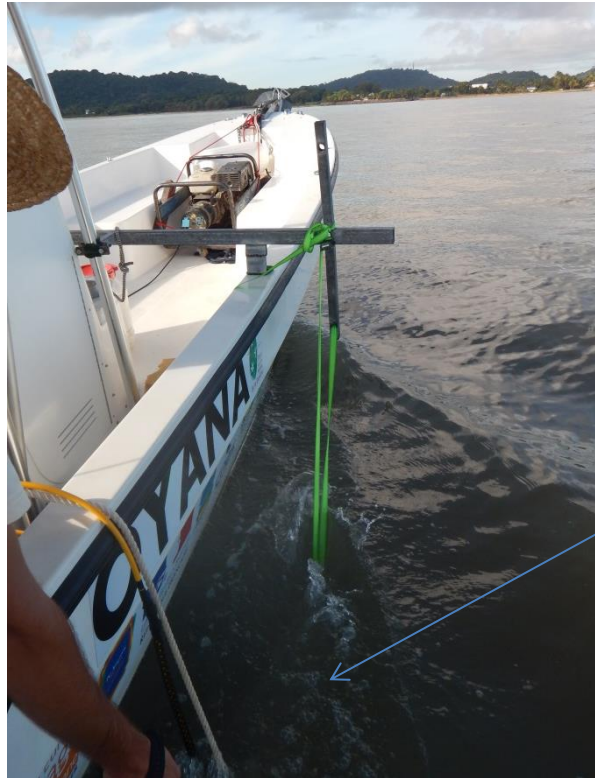
Illustration 10: géométrie d'acquisition du sonar. Le poisson est maintenu au niveau de sa tête à la perche via des sangles et à l'arrière à bout de bras.
