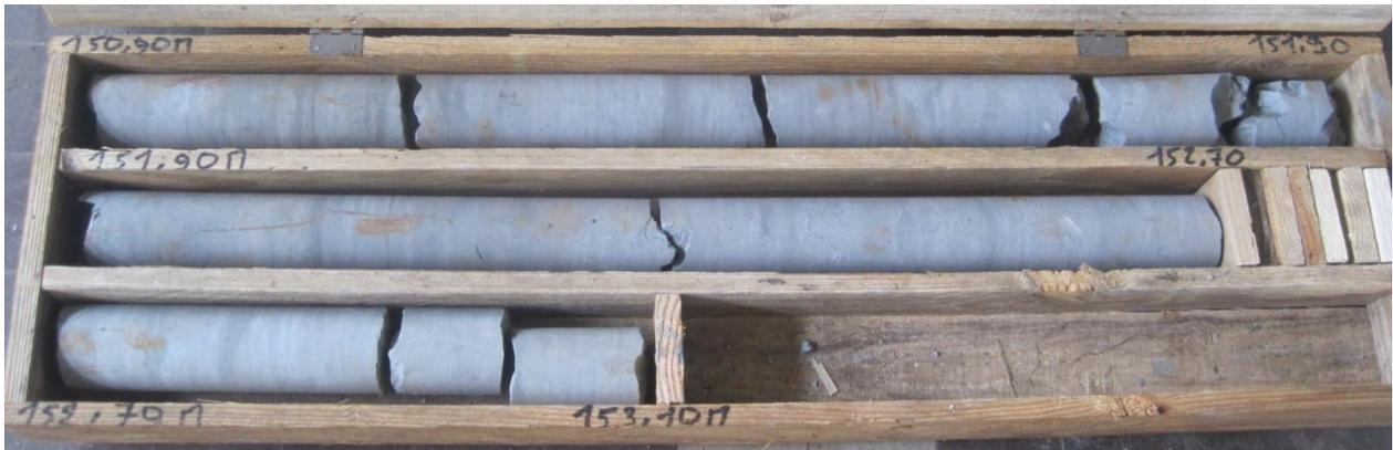
Illustration 21 : Faciès des Gaize de l'Albien supérieur rencontrés dans le forage de la CODAH de Nointot (ici entre 150 m et 153 m de profondeur) – ouvrage BSS 00756X0209
