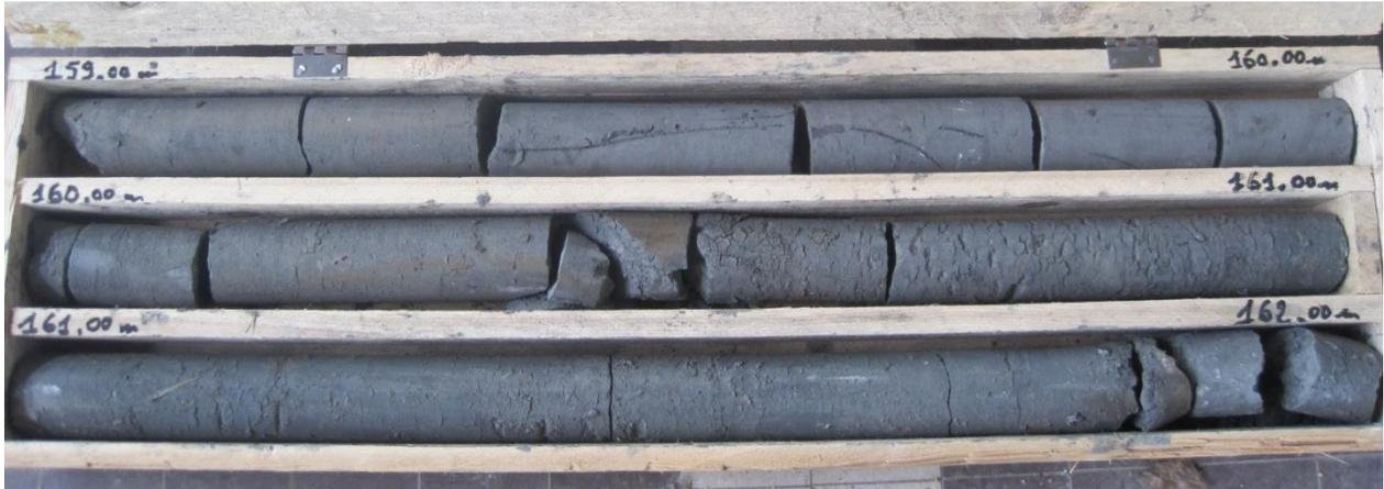
Illustration 20 : Faciès des Argiles du Gault de l'Albien supérieur rencontrés en fin de forage dans le sondage de la CODAH de Nointot (ici entre 159 m et 162 m de profondeur) – ouvrage BSS 00756X0209
