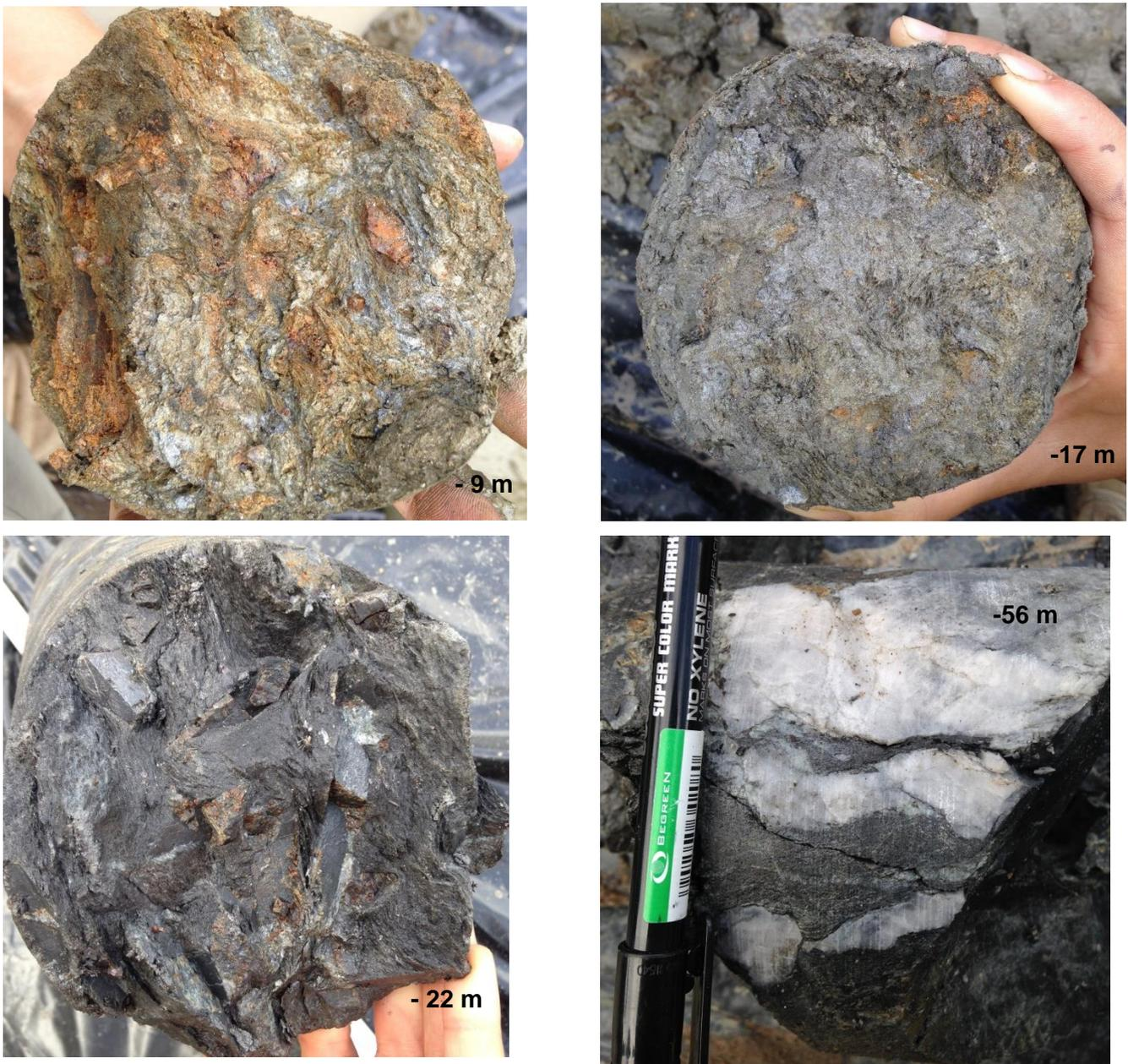
*Illustration 10 : Saprolite oxydée (en haut à gauche), saprolite (en haut à droite), schiste fracturé avec staurotide (en bas à gauche) et schiste avec veine de quartz (en bas à droite). (BRGM)*
