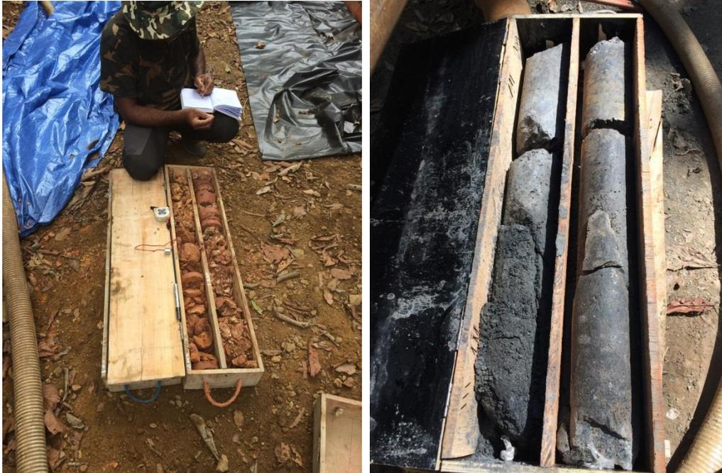
*Illustration 17 : Altérites (à gauche) et socle fracturé entre 74 et 76 m (à droite) sur SR3 (BRGM)*
