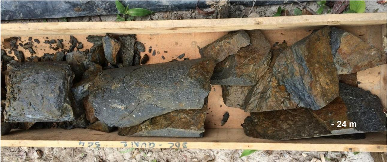
*Illustration 13 : Zone fortement fracturée avec dépôts de « rouille » à 24 m de profondeur sur SR2 (BRGM)*
