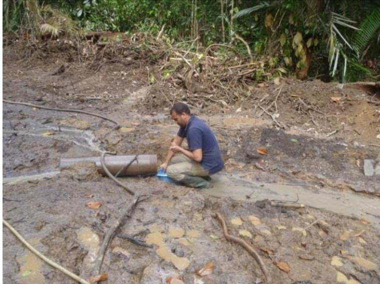
Illustration 35 : Dispositif de mesure du débit mis en place au cours de la foration avec le MFT (BRGM)
