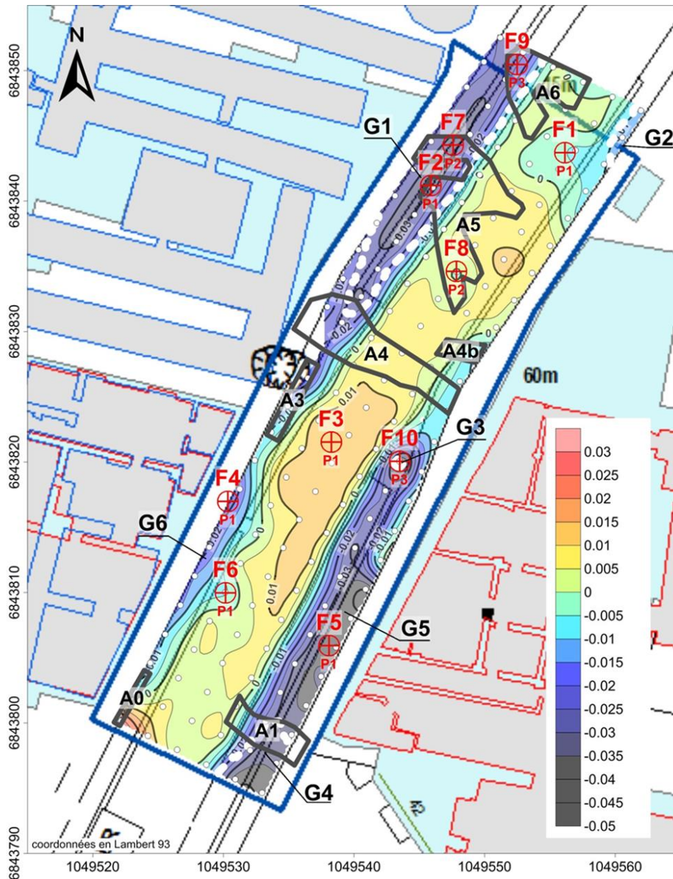
Illustration 3 : Carte d'anomalie gravimétrique et anomalies radar (A0 à A6)
