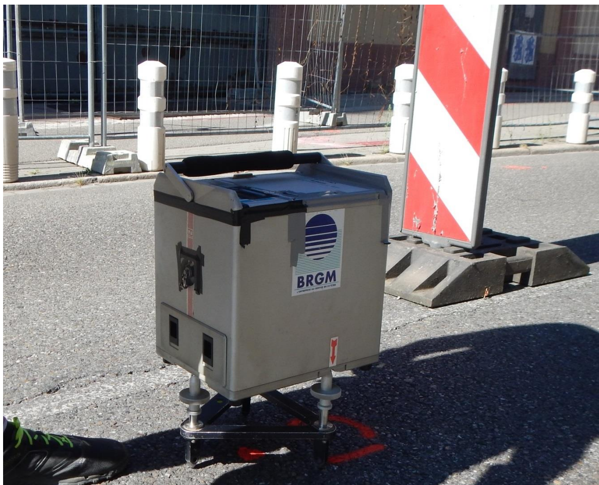
Illustration 8 : Microgravimètre utilisé lors des campagnes d'acquisition géophysique route de Bischwiller
