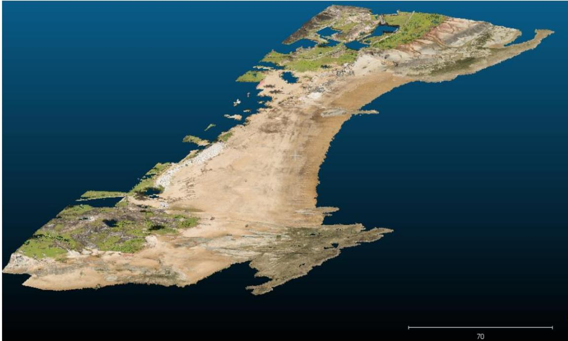
*Illustration 5 : MNT construit à partir de la combinaison des photographies acquises par drone et des fichier de points.*
