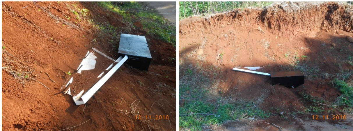
Illustration 26 : Ruissellomètre de talus Mtsamboro amont
