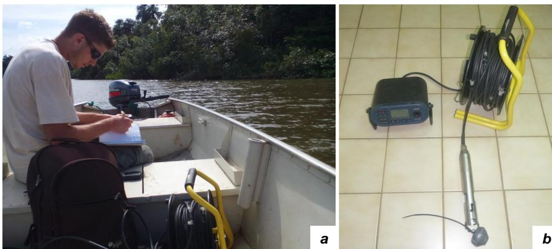
Illustration 4 : Opération de mesure de la conductivité (a) à l'aide d'une sonde lestée (b)
