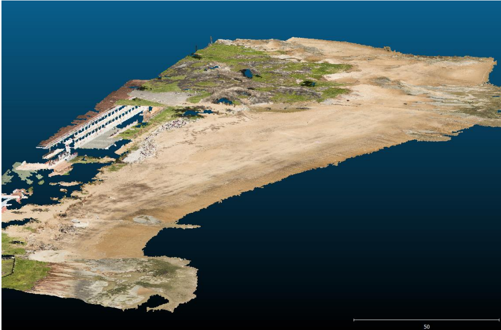
Illustration 4: Nuage de points avec drappage de l'orthophotographie de la plage de l'hôtel des roches à Kourou obtenu après traitement des photos prises par drone (©Aeroproduct & BRGM, 2016)
