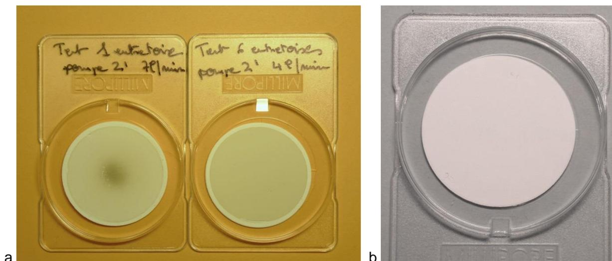
Illustration 26 – Aspect des filtres : (a) situations initiales avec un débit de pompe à 7l/min + cassette courte puis avec un débit de 4 l/min + cassette avec chambre de dispersion et (b) situation finale avec un débit de 3 l/min et une cassette en polypropylène chargé en carbone et entertoise en aluminium
