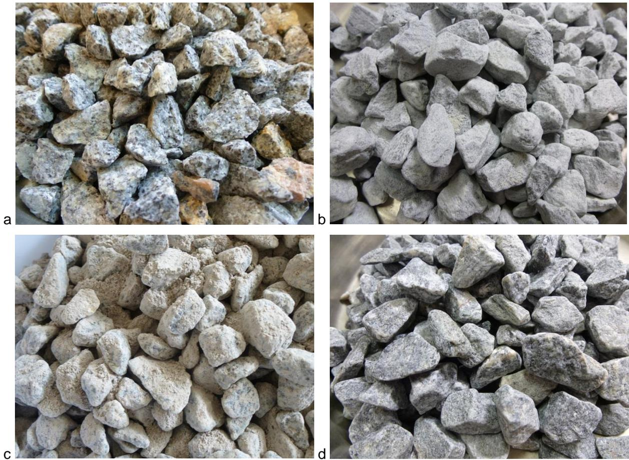
*Illustration 16 – Les granulats avant(a) et après essai d'attrition (b) ; aspect en fin d'essai avec les fines produites au cours de l'essai (c) et même échantillon après lavage (d) (GRAN) ( les grossissements photographiques sont approximativement les mêmes)*
