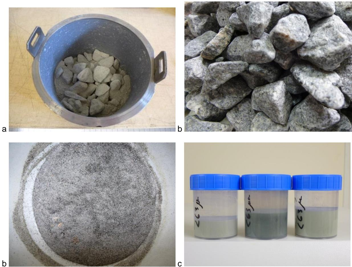
Illustration 36 – Résidu d'échantillon après essai d'attrition (a) et granulats lavées (b)
