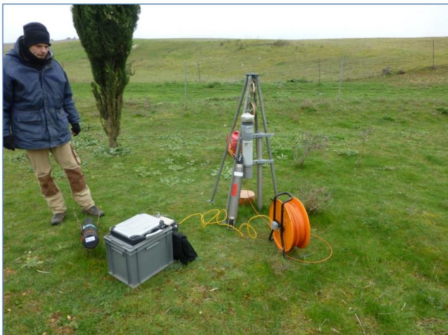
*Figure 3 : sonde Idronaut 316Plus utilisée pour les investigations dans le forage de Labruguière.*
