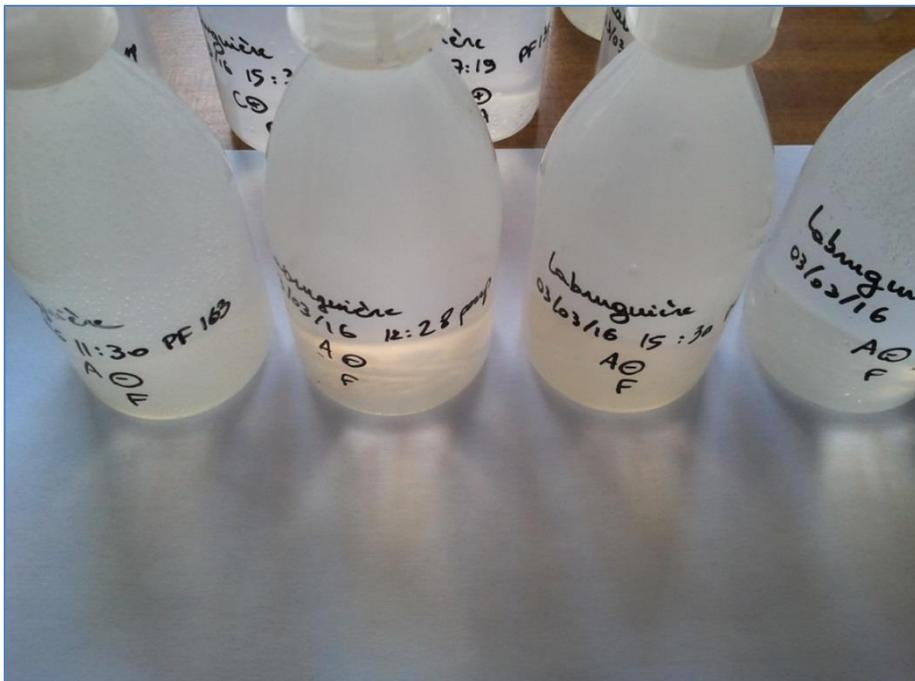
Figure 37 : état visuel des flaconnages anions (filtration 0,45  $\mu$ m) ; à gauche et à droite, suite à prélèvement de fond ; au centre, suite à pompage – piézomètre de Labruguière.
