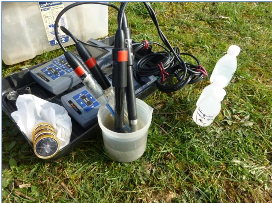
Figure 24 : état de l'eau et des filtres 0,45 µm à l'issue de la 1<sup>ère</sup> séquence de pompage : présence importante de fines – piézomètre de Labruguière.
