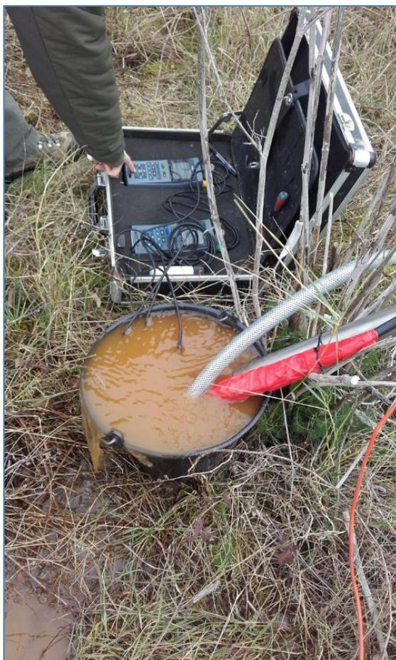
Figure 65 : eau pompée en début de purge à 45 m de profondeur le 01/03 – piézomètre de Valdurenque.
