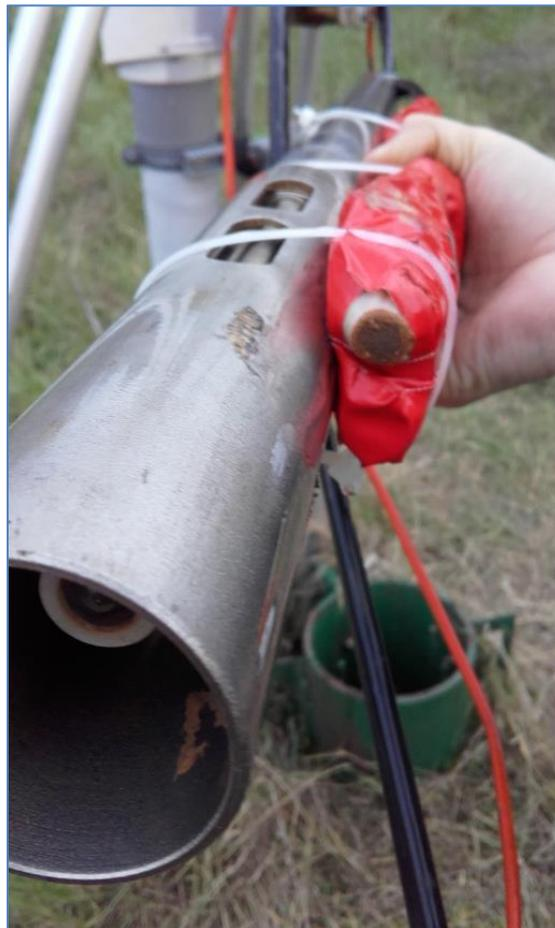
*Figure 64 : couplage du système de prélèvement de fond à la sonde Idronaut. Remarquer le colmatage du filtre (partie apparente du préleveur de fond, lui-même protégé par du scotch rouge) – piézomètre de Valdurenque.*
