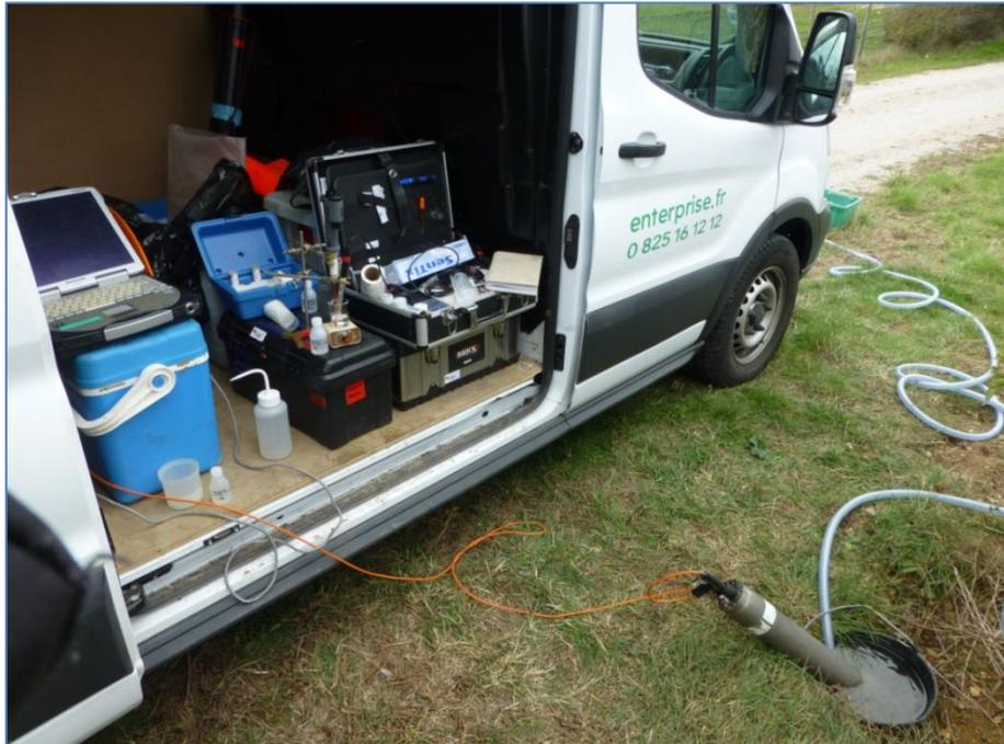
Figure 30 : détail de l'exhaure du pompage et aperçu du monitoring physico-chimique à l'aide de la sonde Idronaut 316Plus – piézomètre de Labruguière.
