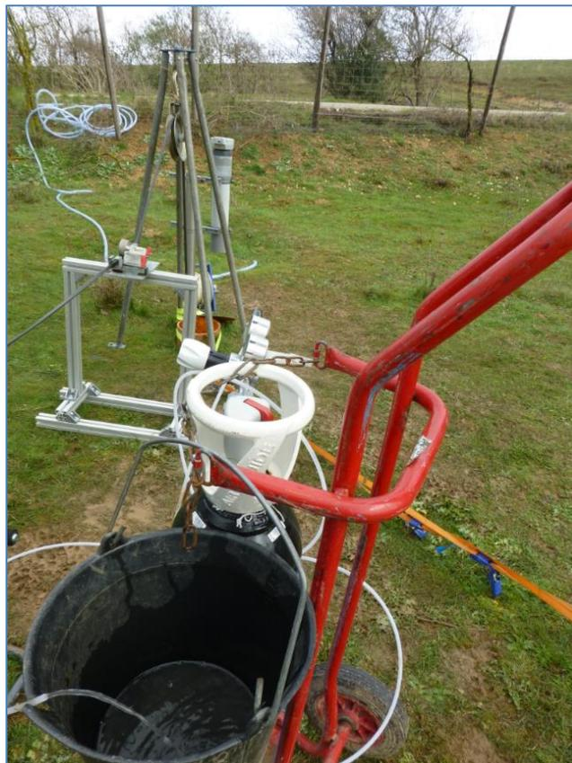
Figure 26 : vue de détail du dispositif de prélèvement de fond en fonctionnement – piézomètre de Labruguière.
