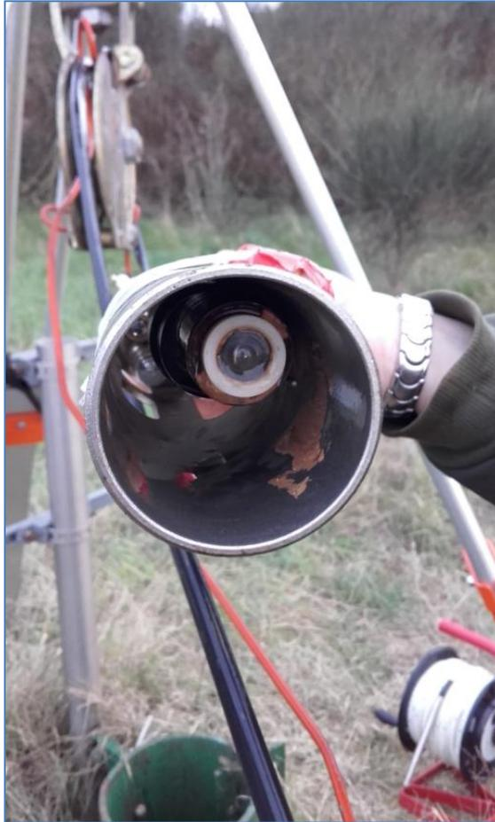
*Figure 66 : aperçu des dépôts remontés par la sonde Idronaut (oxydes et/ou hydroxydes de fer notamment) – piézomètre de Valdurenque.*
