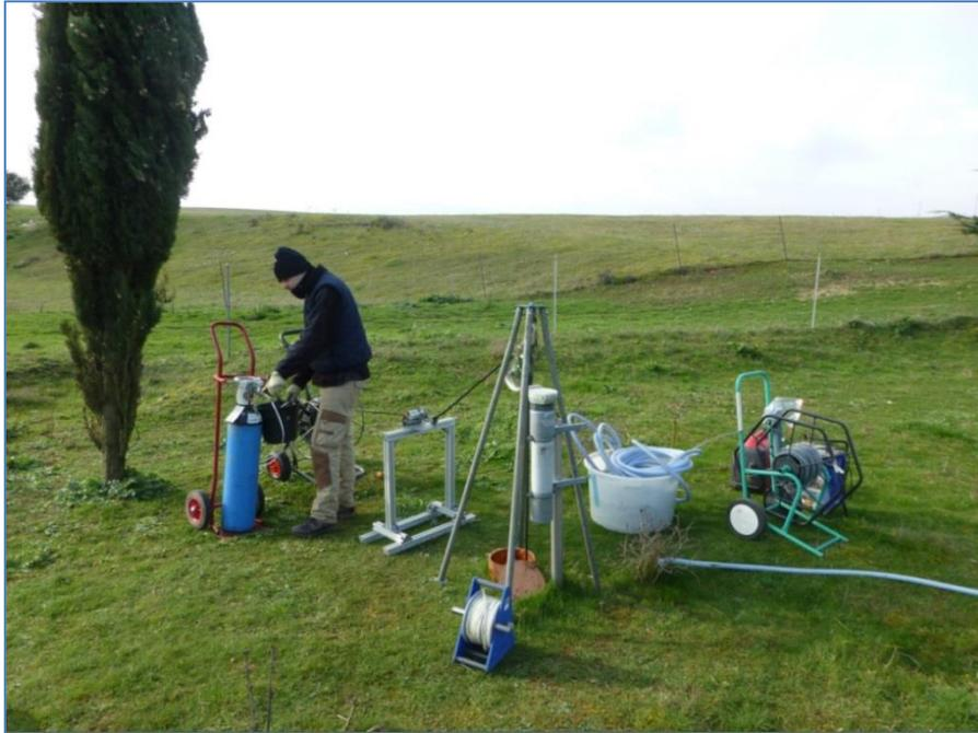
Figure 25 : à gauche du forage : dispositif de prélèvement de fond (bouteille d'azote, enrouleur avec tuyau bitube) ; à droite du forage : matériel nécessaire au pompage – piézomètre de Labruguière.
