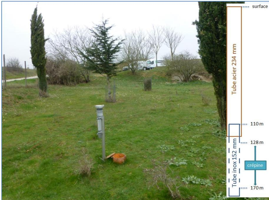
Figure 2 : piézomètre de Labruguière – vue générale et rappel schématique de la coupe technique.
