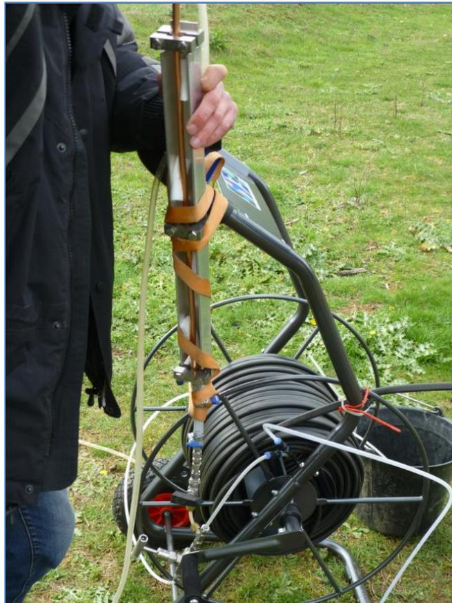
Figure 28 : vue de détail du dispositif d'échantillonnage des gaz rares couplé au système de prélèvement de fond – piézomètre de Labruguière.
