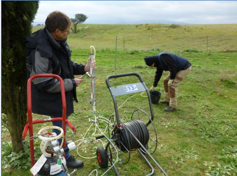
Figure 27 : vue d'ensemble du dispositif d'échantillonnage des gaz rares couplé au système de prélèvement de fond – piézomètre de Labruguière.
