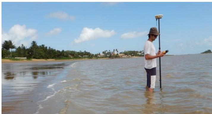
Illustration 2: Station mobile du GPS positionnée sur une canne pour les profils de plage (BRGM)
