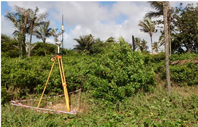
*Illustration 1: Station fixe du GPS positionnée sur un repère fixe dans l'anse de Montabo (BRGM)*
