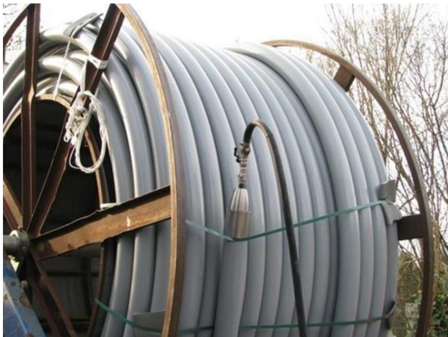
Figure 14 : Vue du touret où est enroulé une sonde coaxiale en PEHD-Xa de 450 m de profondeur et 90 mm de diamètre (Source Rehau, Projet Zumikon, Suisse)
