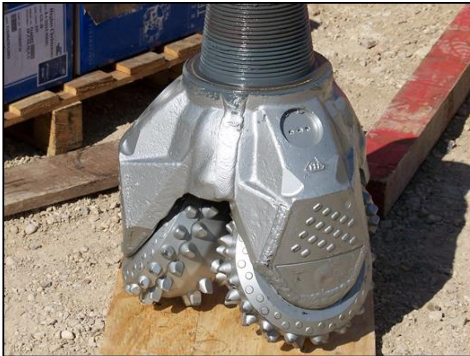
Figure 2 : Trépan « tricône » utilisé dans le cadre des forages destructifs de type rotary.
