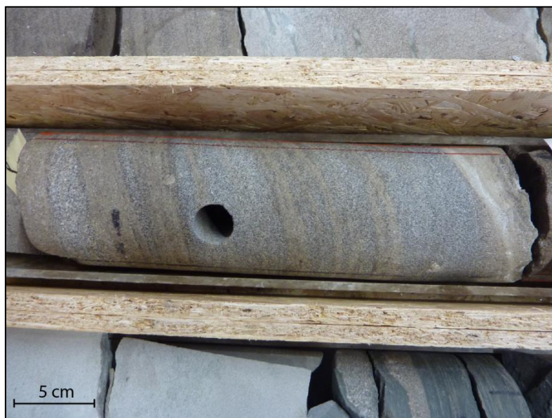
Figure 1 : Carotte issue d'un forage carotté au Trias (bassin de Paris) dans laquelle a été prélevé un échantillon ( plug ) pour réaliser une mesure de couple porosité/perméabilité.
