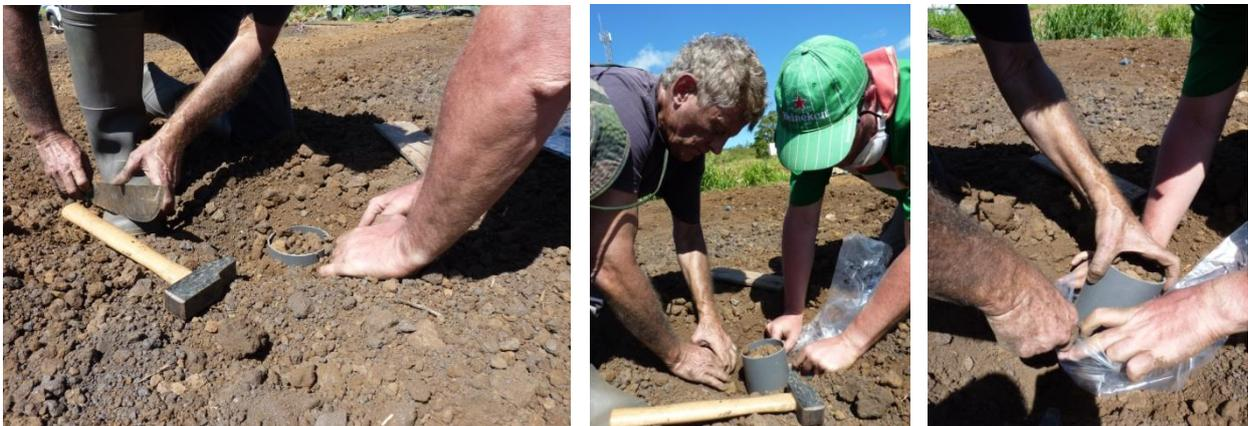
Illustration 19 : Prélèvement de sol pour la mesure de la densité apparente avant et après compaction.
