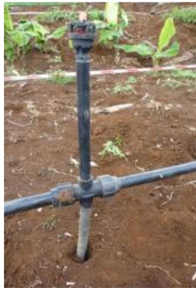
*Illustration 28 : Asperseur utilisé pour l'irrigation.*
