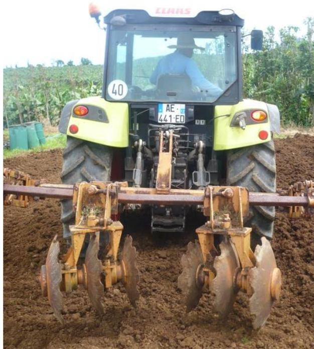
*Illustration 24 : Billonneuse utilisée pour la préparation du sol avant les plantations.*
