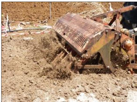
Illustration 5 : Rotobêche (propriété CIRAD) utilisée pour l'incorporation des amendements sur les modalités P1, P5 et P6.
