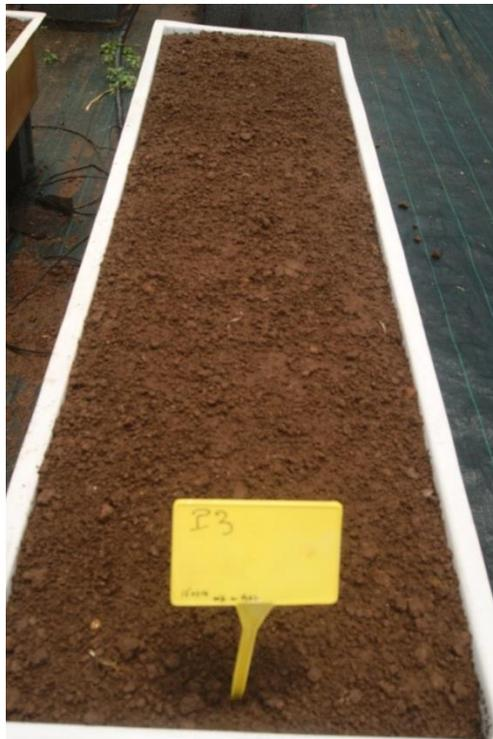
*Illustration 35 : Dispositif en serre mis en place pour l'essai de culture sur sol alluvionnaire après traitement par ISCR (photographie de Luc Rangon, IRD).*
