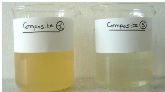
Illustration 58 : Couleur de l'eau des échantillons d'eau d'irrigation « Composite 1 » et « Composite 5 ».
