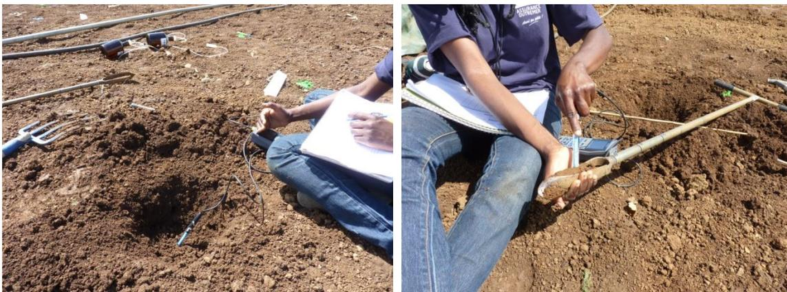
Illustration 17 : Mesures redox dans l'horizon 0 - 20 cm à gauche et dans l'horizon 20 - 30 cm à droite.
