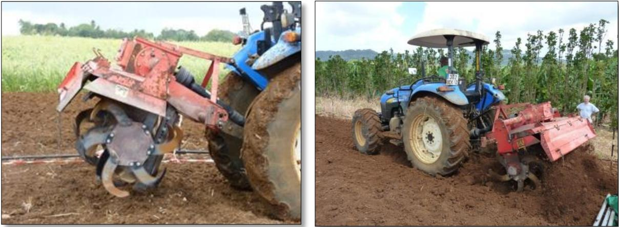
*Illustration 6 : Rotoculteur (propriété FMC-Adventus) utilisé pour l'incorporation des amendements sur les modalités P3 et P4.*
