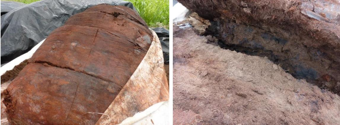
Illustration 14 : État des amendements Daramend standard (2 photos du haut) et Daramend bagasse (2 photos du bas) à la surface (gauche) et à l'intérieur (droite) des bigs bags lors du lancement des travaux.
