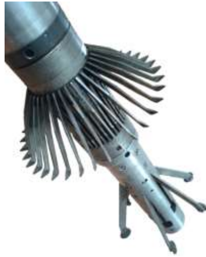
Figure 1. Exemple de diamètreur mécanique à 40 bras
