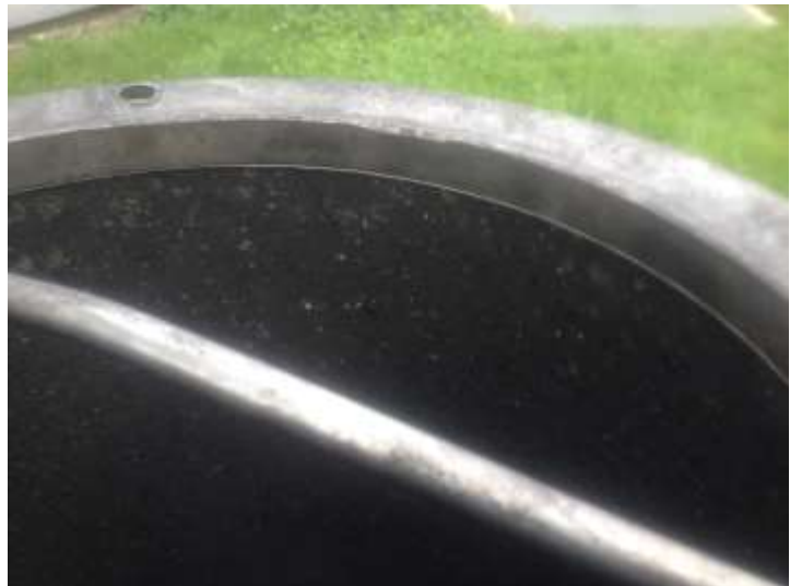
Figure 3 : Débris sous forme de plaques de sulfure de fer et morceau d'un bridge-plug reforé
