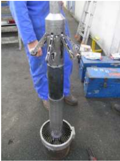
Figure 1. Exemple de diamètreur mécanique à 40 bras
