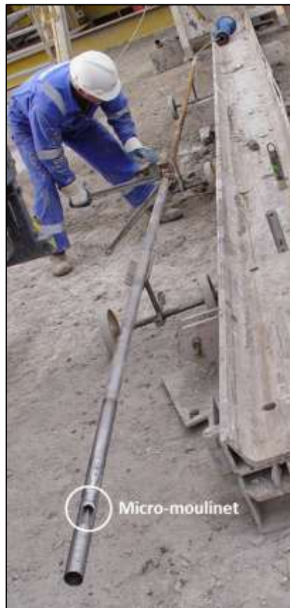
Figure 3 : Exemple de flowmètre utilisé pour la mesure du débit dans le puits
