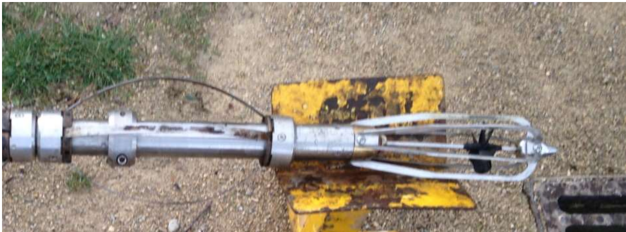
Figure 7 : Capteur de vitesse d'un outil PLT
