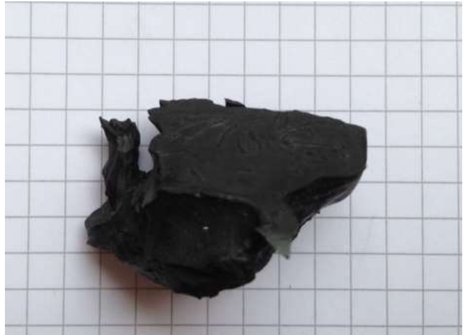
Figure 3 : Débris sous forme de plaques de sulfure de fer et morceau d'un bridge-plug reforé
