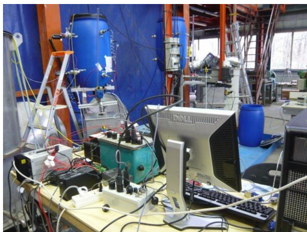
Figure 25 : Dispositif pour la recirculation du lixiviat.
