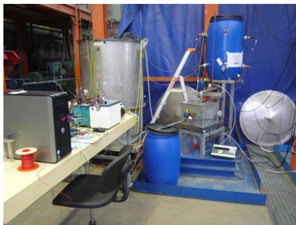
Figure 25 : Dispositif pour la recirculation du lixiviat.
