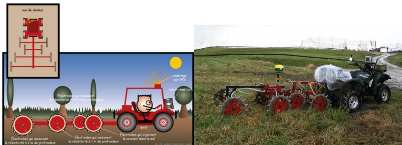
Figure 11 : Illustration de la méthode ARP et photo prise sur une décharge.
