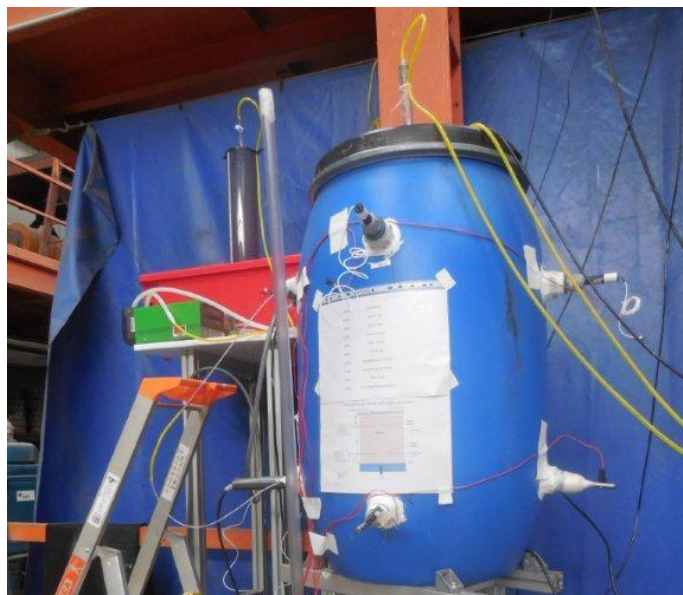
Figure 35 : Photo du dispositif expérimental, avec la colonne d'eau à gauche permettant le maintien des conditions anaérobies dans le réacteur.
