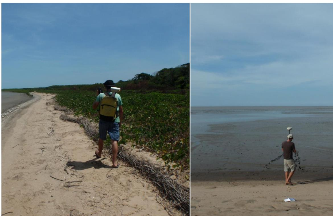
Figure 4 - Station mobile du GPS positionnée sur une canne pour les profils de plage (photo de droite) et sur un sac à dos pour le levé du trait de côte (photo de gauche)
