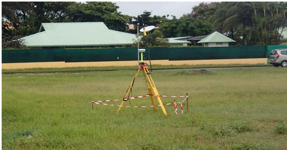
Figure 3 - Station fixe du GPS positionnée sur un repère fixe à Kourou
