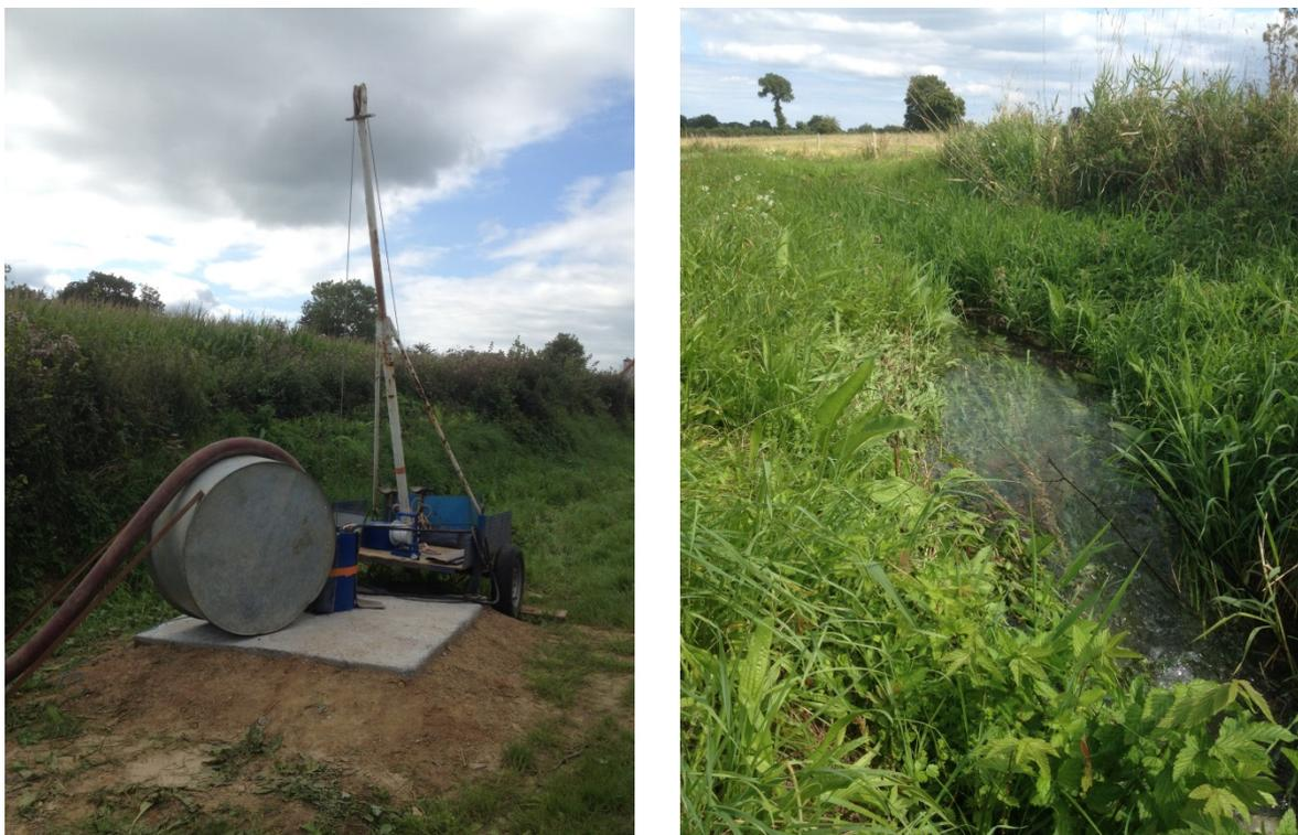
*Illustration 14 : Photographie du dispositif de pompage (gauche) et du rejet dans le bas côté 100 m en aval (Droite)*
