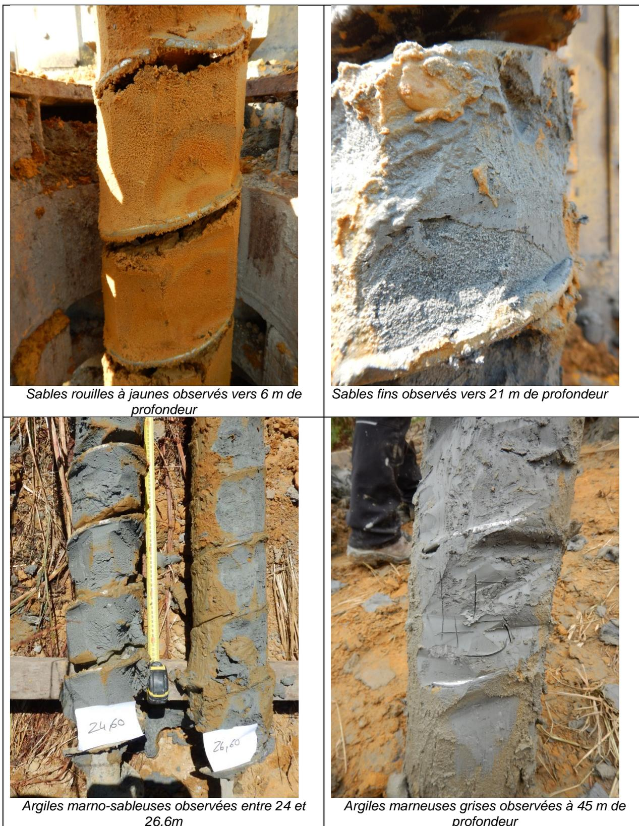
*Illustration 32 : Photographies des principales lithologies observées dans le forage 01175X0013/RTE-F3*
