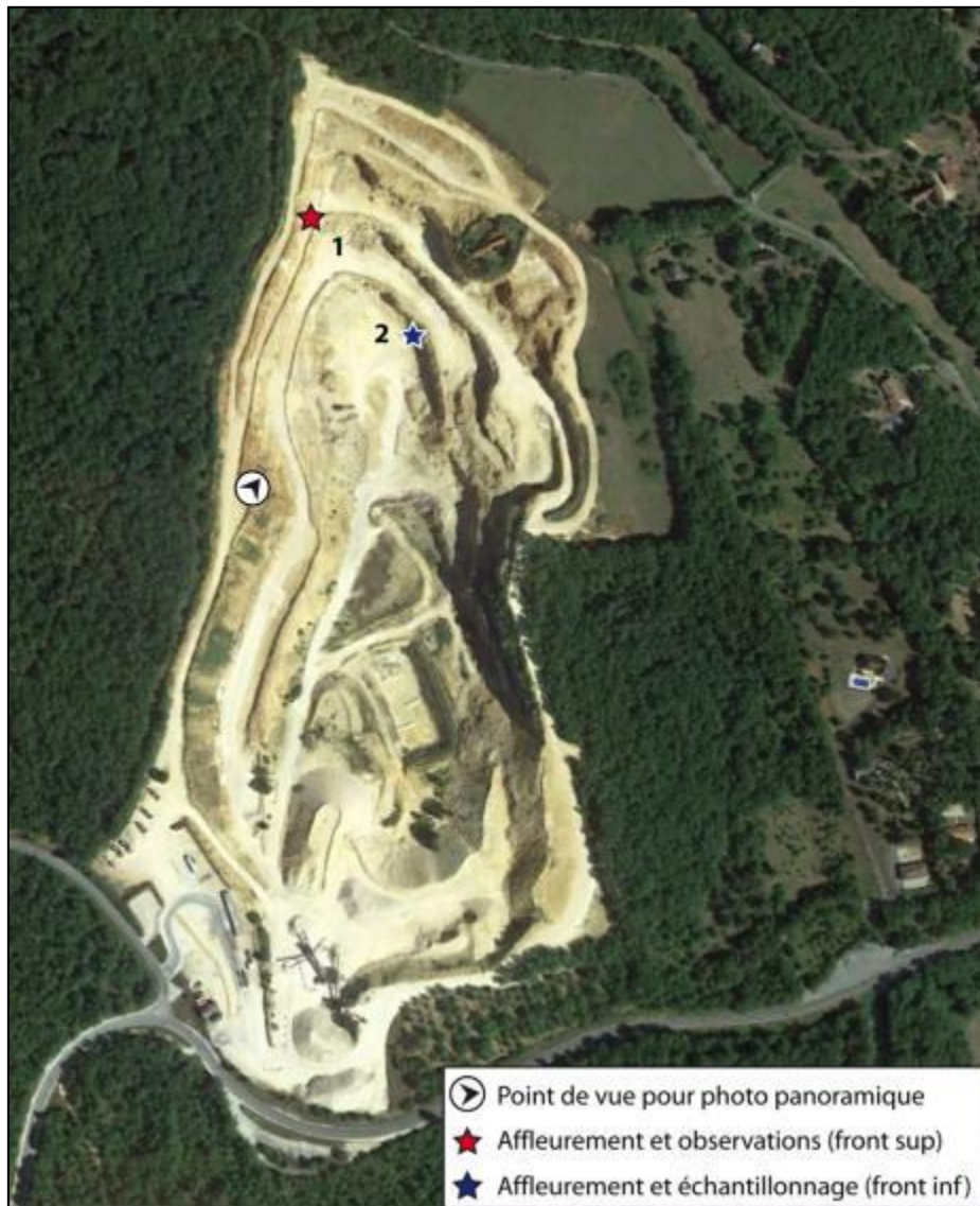
Figure 14 : Vue aérienne de la carrière « Bretonnier ». Positionnement du point de vue de la photo panoramique (Figure 15) et des affleurements étudiés et/ou échantillonnés, en rouge sur le front supérieur et en bleu sur le front inférieur.
