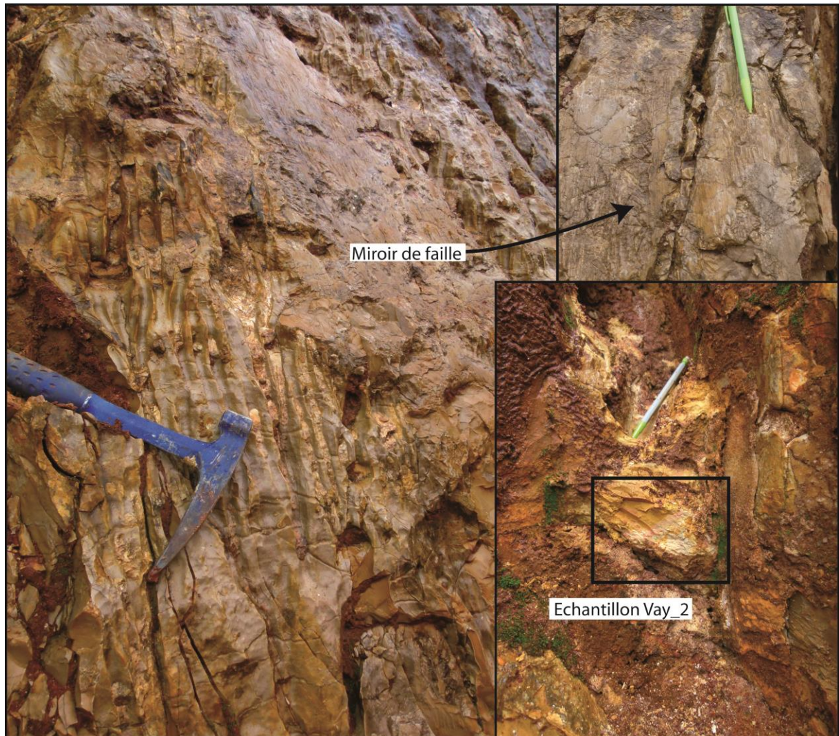
Figure 21 : Photo de l'affleurement n°3. A gauche : miroir de faille et cannelure de dissolution remplie par une boue micritique jaunâtre. En haut à droite : stries, stylolite et précipitation de calcite indiquant le jeu polyphasé de la faille. En bas à droite : Echantillon Vay_2 prélevé.
