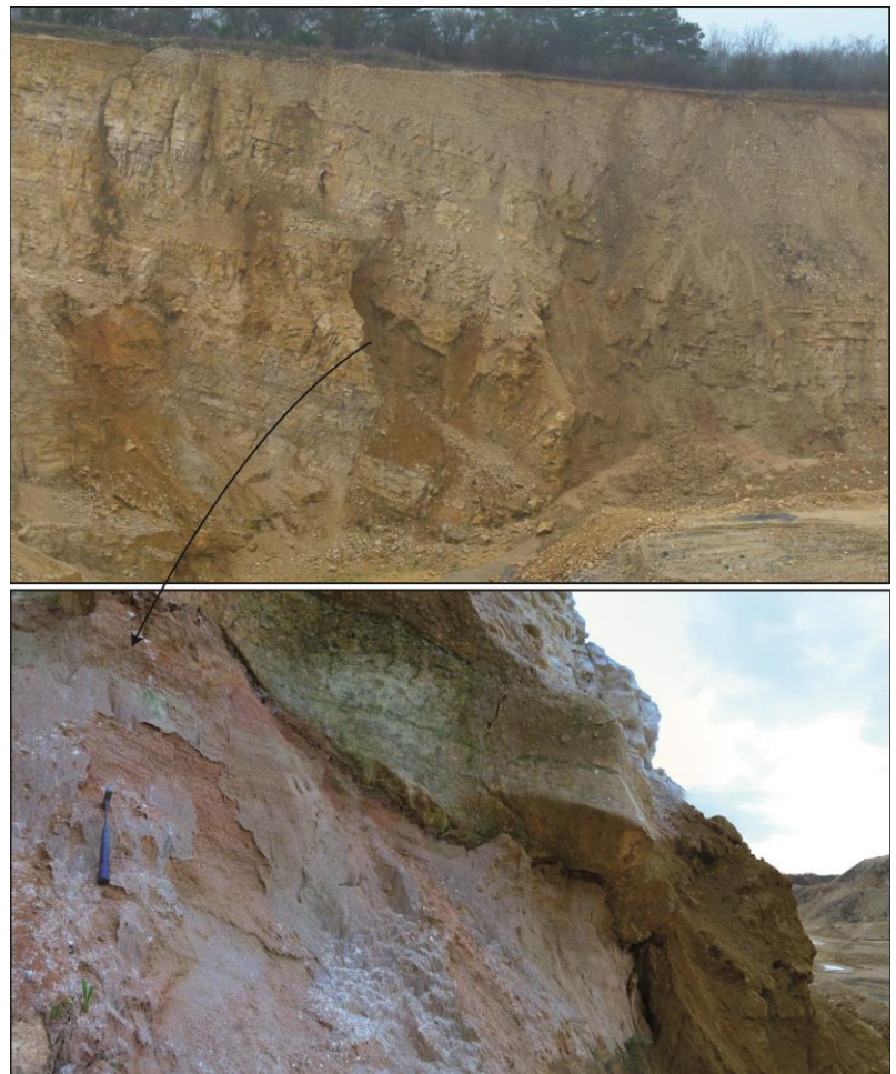
Figure 9 : Photo de l'affleurement vue du point panoramique A (Figure 1) présentant la cavité n°5 échantillonnée. Le zoom montre un remplissage karstique sableux ocre-rouge lité correspondant à l'échantillon Peusec 2 (Peu 2).
