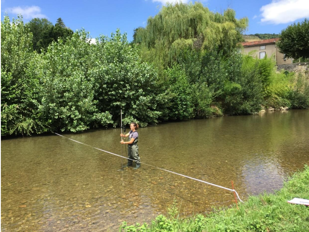
Jaugeage au courantomètre acoustique sur l'Arize
