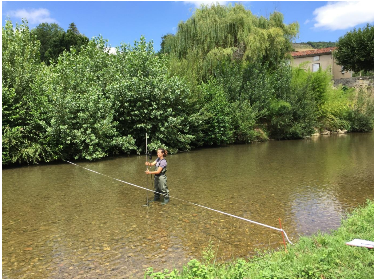
Jaugeage avec le courantomètre acoustique sur l'Arize
