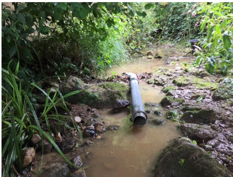
Jaugeage au seau et au tuyau sur un affluent de l'Arize
