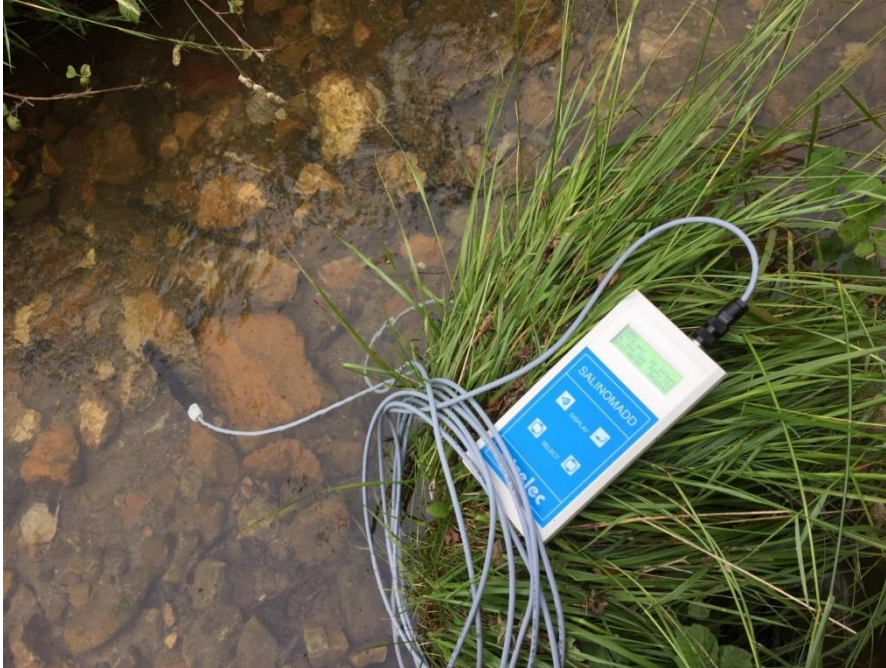
Jaugeage au sel sur le ruisseau du Camarade
