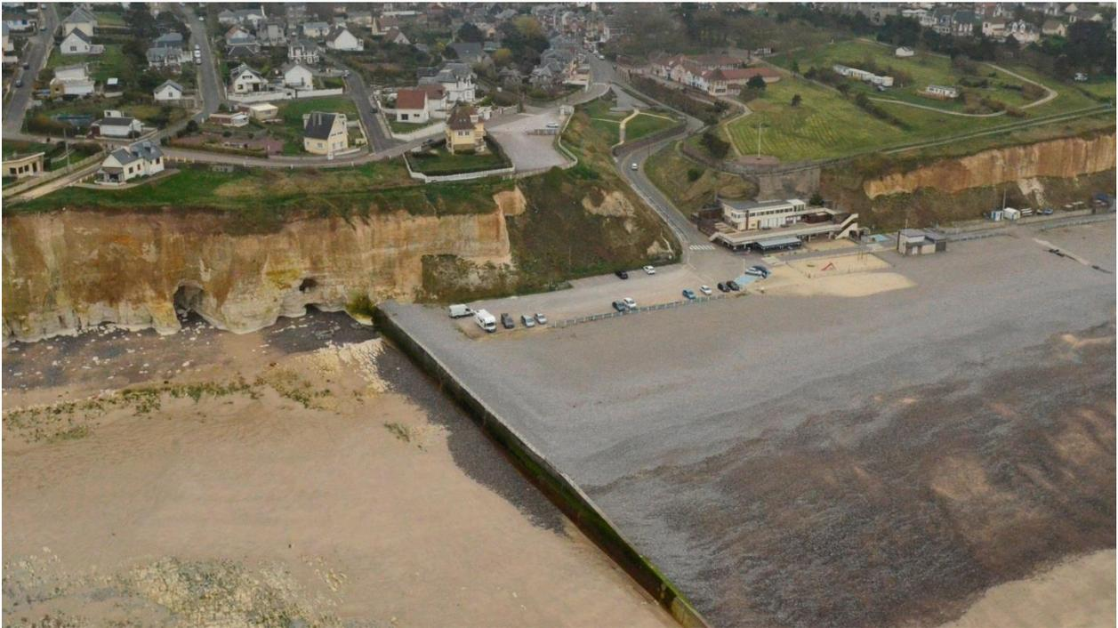
*Illustration 65 : Exemple d'ouvrage transversal bloquant le cortège sédimentaire (Mesnil-Val - Criel-sur-Mer, mars 2014)*
