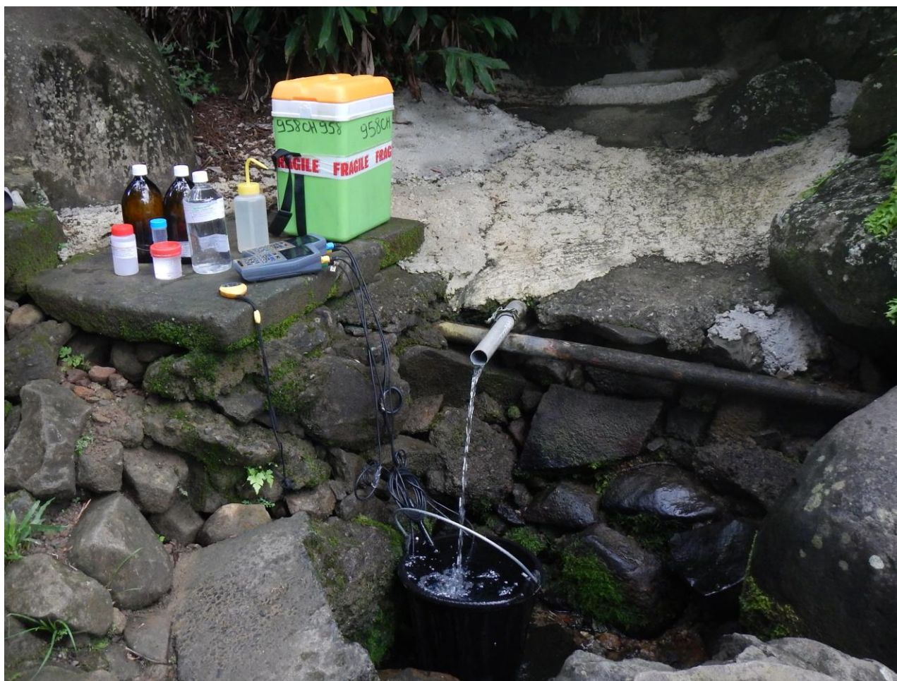
Illustration 5 : Prélèvements d'eau et mesures des paramètres physico-chimiques in situ à la source Desmarinières à Rivière Salée
