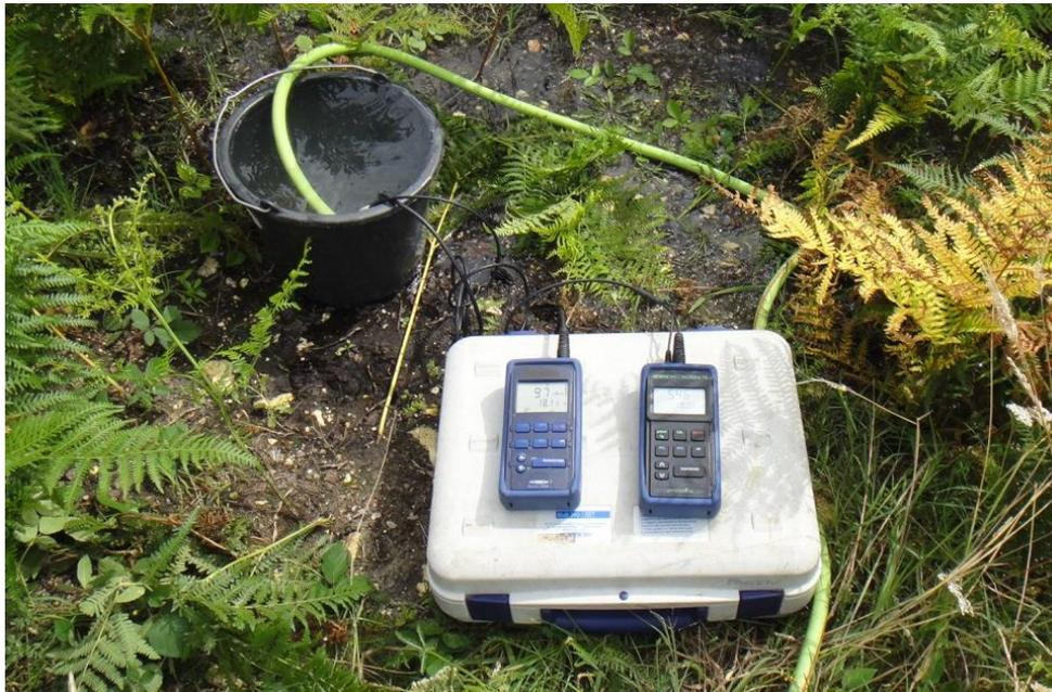
Illustration 36 : Multimètres et sondes mesurant le pH, la température et la conductivité
