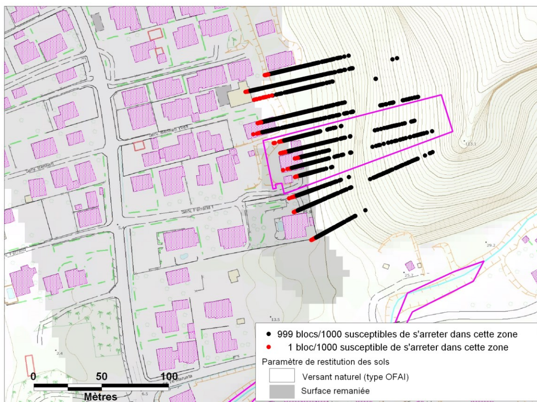
Illustration 3 : Etude trajectographique (1000 lâchers de blocs de 1,4 à 3.3 T) avec le logiciel Pierrauto @BRGM
