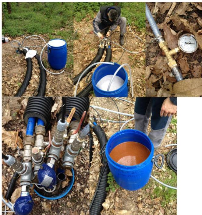
Figure 6 : Photographies du dispositif mis en place le 24 avril 2015 pour purger une sonde double U de 50 m de profondeur sur la plateforme expérimentale du BRGM.
