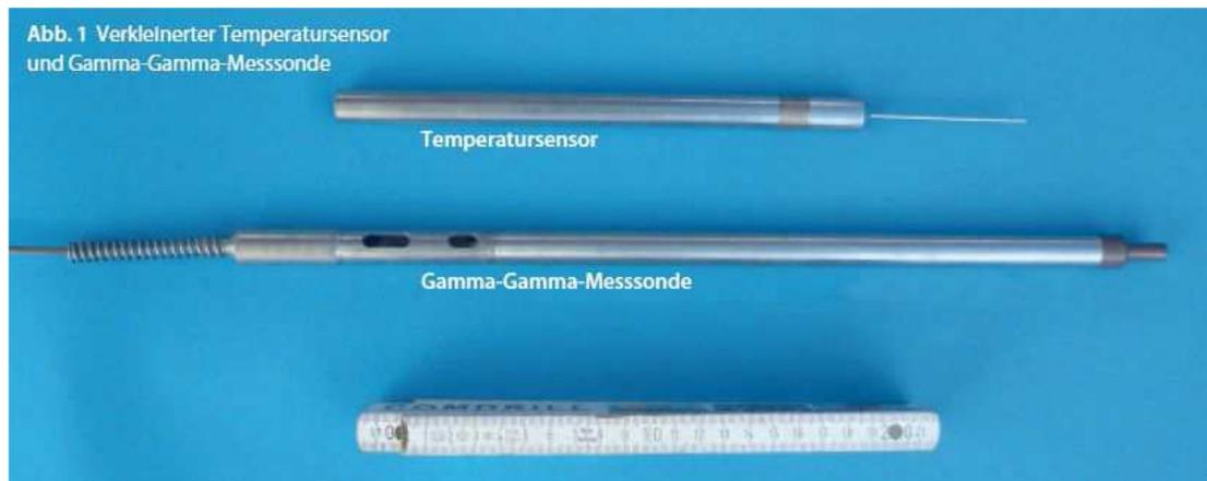
Figure 16 : Sonde température et sonde gamma—gamma Dr. Voutta
