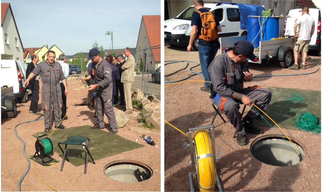
*Figure 8 : La sonde de température est liée à un tire fil (à gauche) puis descendu dans la sonde géothermique (à droite).*
