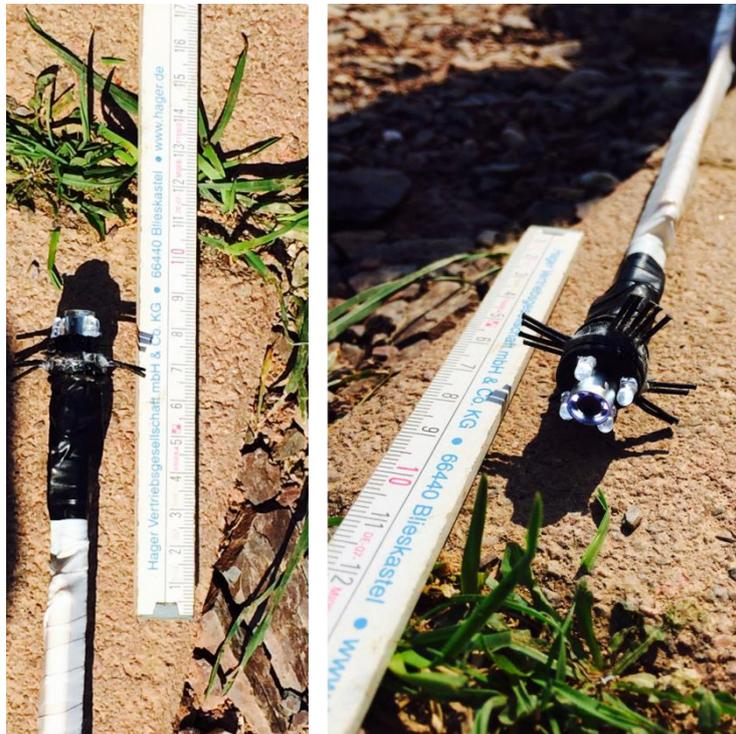
*Figure 24 : Photographie de la caméra 12 mm.*
