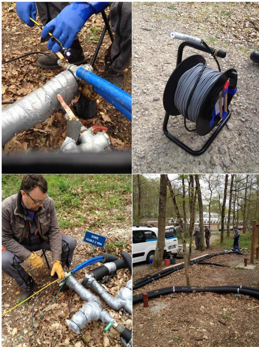
Figure 5 : Dispositif pour réaliser les inspections vidéo. En haut à gauche : caméra non étanche avec dispositif de centrage (anneaux en caoutchouc) et dispositif d'éclairage (leds) prête à être insérée dans le tube de sonde. En haut à droite : caméra étanche. En bas à gauche : insertion de la sonde de température avec le câble guide jaune. En bas à droite : vue d'ensemble sur les liaisons horizontales des sondes géothermiques (gaines calorifugées) de la plateforme expérimentale du BRGM.
