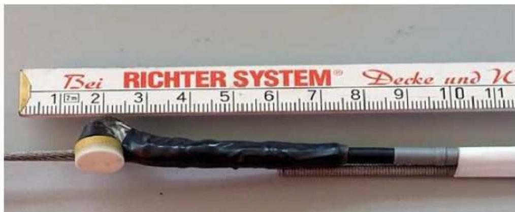
Figure 15 : Prototype sonde à ultra-sons avec fréquence de 1 Mhz
