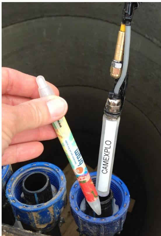
Figure 18 : Photographie d'une des caméras étanches.
