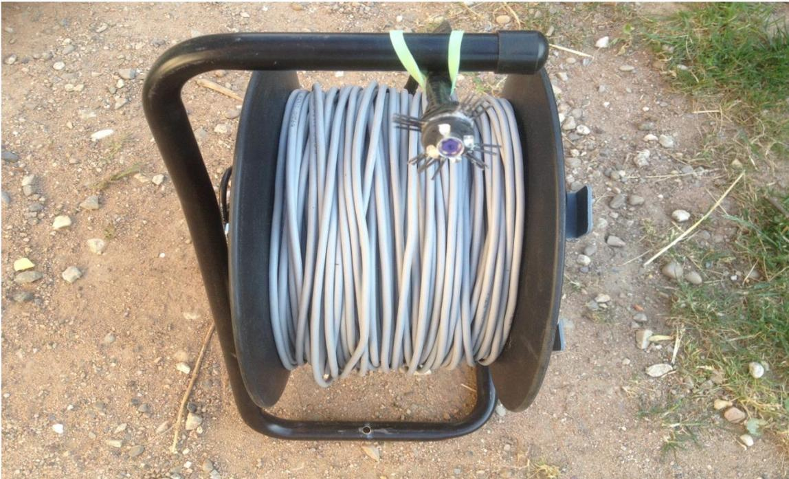
Caméra non étanche de 8 mm de diamètre, fixée sur la fibre de poussée.
