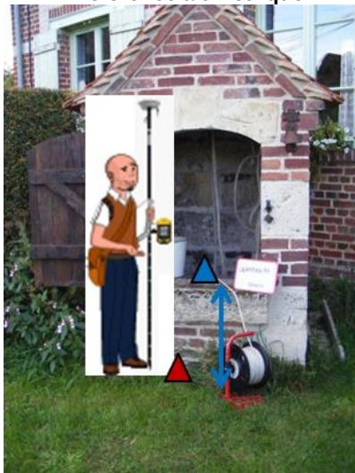
Illustration 17- Mesures GPS de la référence altimétrique et différence avec le repère de mesure et le sol.
