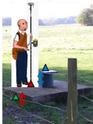
Illustration 17- Mesures GPS de la référence altimétrique et différence avec le repère de mesure et le sol.
