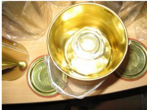
*Illustration 66 : Système de prélèvement utilisé pour les CFC et SF6*
