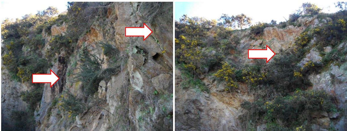
Illustration 12 : Plans de décompression menaçants ouverts avec des ouvertures de plusieurs centimètres (au bout des flèches ; illustration 9 pour la localisation)
