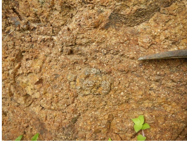
Illustration 18 - Texture sablo-argileuse des conglomérats polygéniques altérés
