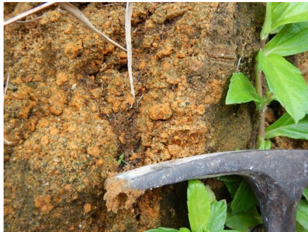
Illustration 7 - Eléments ponceux dans une matrice argilo-sableuse ocre
