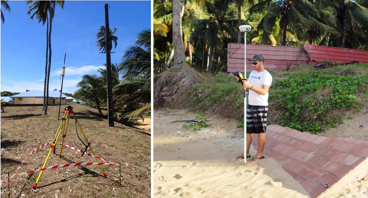
*Illustration 8 : Dispositif GPS différentiel, avec la station fixe à gauche et la station mobile à droite, pour le levé d'un profil de plage*
