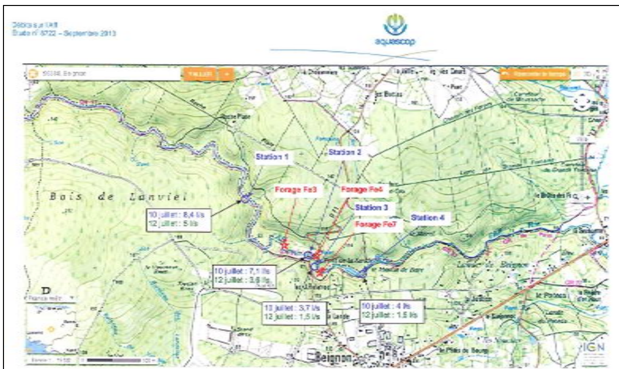
Illustration 26 : Mesures de débit de le long de l’Aff au niveau des captages ; mise en évidence de zones de pertes au sein du cours d’eau ; Rapport Aquascop, 2013.
