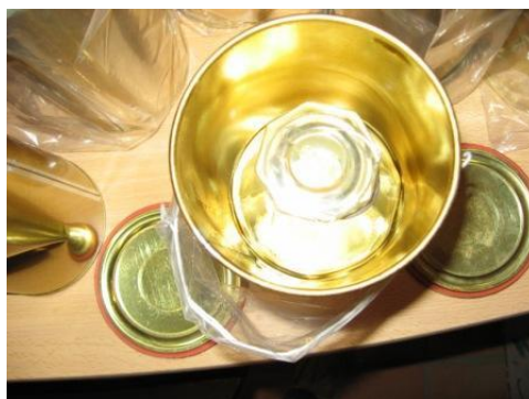
Illustration 8 - Système de prélèvement utilisé pour les CFC et SF 6
