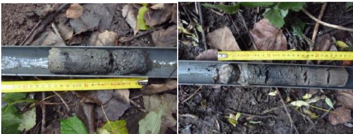
Figure 10 : photographies des sédiments prélevés par ICF Environnement dans le ruisseau du Moulinet
