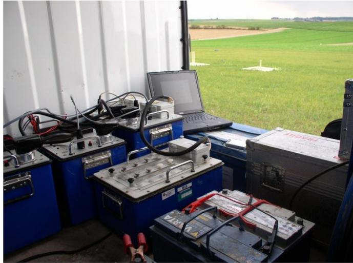
Figure 3 - Équipement de Résonance Magnétique Protonique « NUMIS+ » sur site.
