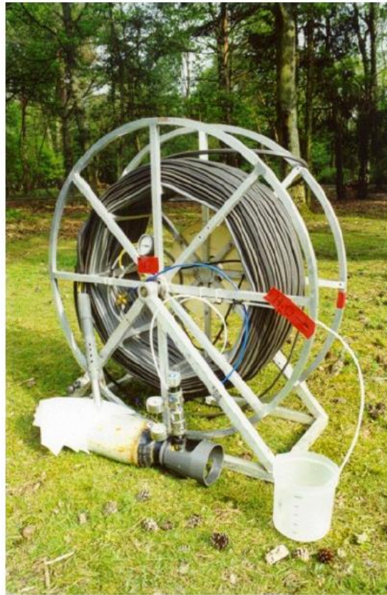
Illustration 13 : Exemple de prélèveur mobile avec 300 m de bitube rilsant protégé par une membrane sur touret de capacité 600 m et bouteille portable d'azote sous pression
