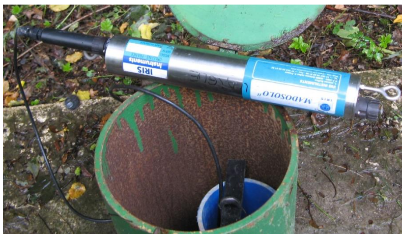
Illustration 5 : Appareil de mesure piézométrique et d'enregistrement Madofil (IRIS ©)
