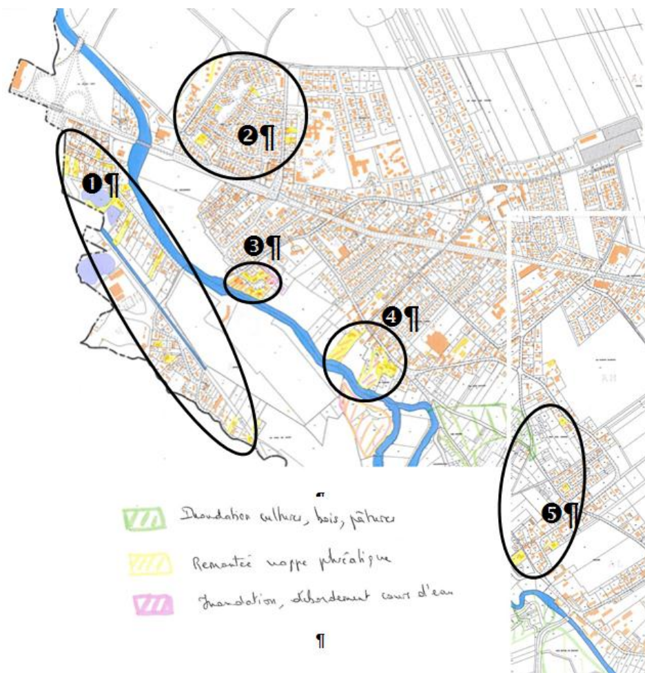
Figure 9 – Exemple de plan de localisation des sinistres de mai 2013 à Saint-Parres-Tertres dans l'Aube – 5 secteurs touchés par les remontées de nappe (extraits du cadastre communiqué par la Mairie)
