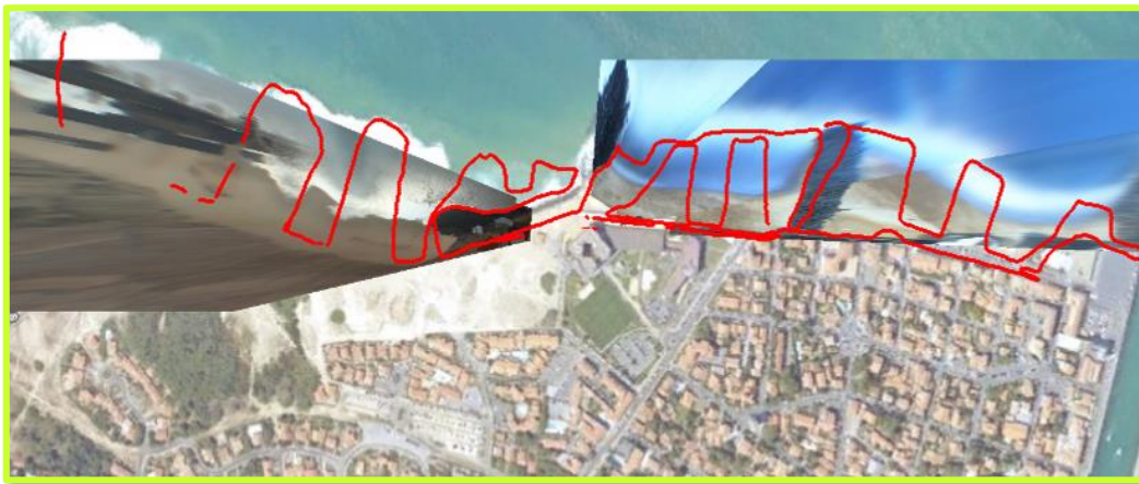
Figure 11 : Représentation en plan des images vidéos sur le site de Capbreton (en rouge : levés DGPS, nord à droite de l'image, sources © CASAGEC Ingénierie).
