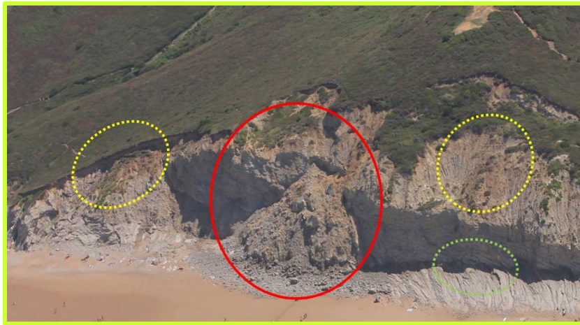
Figure 18 : Zone éboulée en 2012 et photographiée de 2013 (Le Collen). La zone marquée par un cercle rouge correspond à la zone d'éboulement de novembre 2012. Les cercles jaunes indiquent des zones en sommet de falaise où des instabilités de moindre importance ont eu lieu. Le cercle vert pointe l'emplacement d'un cône d'éboulis disparu entre 2008 et 2013 (déblaiement par l'océan).
