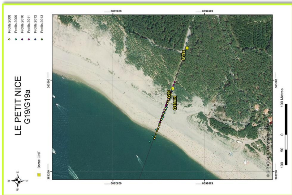
Figure 12 : Données topographiques obtenues depuis 2008 sur le secteur du Petit Nice (Commune de La-Teste-de-Buch). A) Plan de positionnement des points levés au DGPS ; B) Profils de plage levés sur le profil transverse théorique G19.
