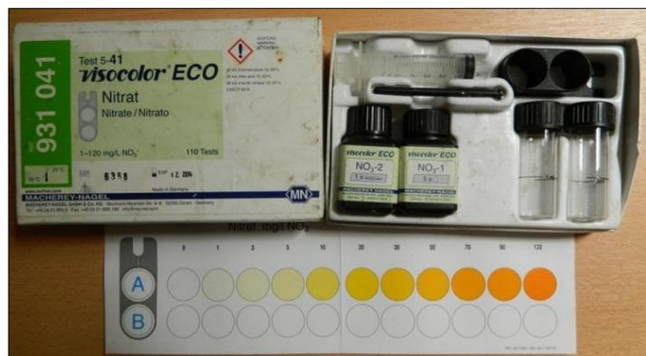
Illustration 44 : Dispositifs utilisés pour caractériser la chimie des points d'eau
